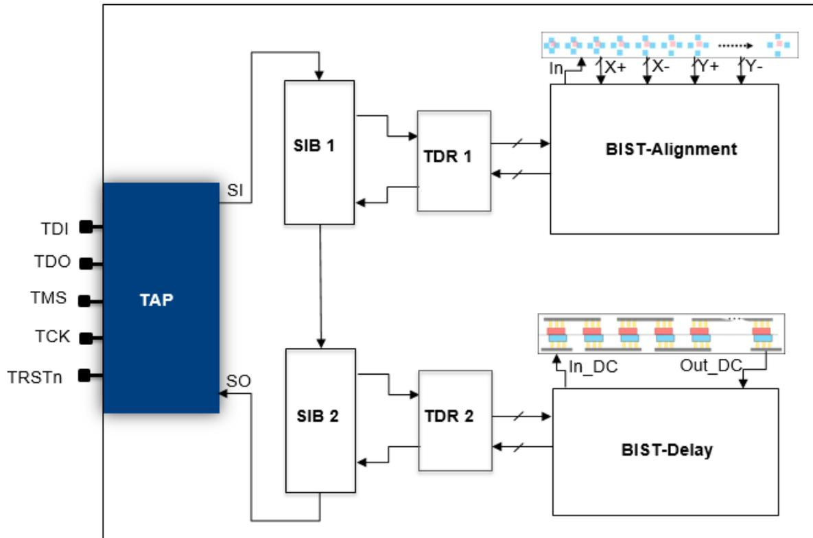
Les deux BIST, intégrés dans la norme JTAG IEEE 1687, permettent de tester et de mesurer les défauts de désalignement avec une grande précision (BIST-Alignment) et de mesurer le retard de propagation d'un signal périodique dans une chaîne d'interconnexions Cu-Cu (BIST-delay).
