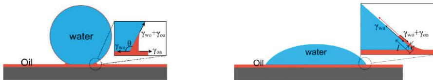
Fig. I.30: Schéma illustrant la géométrie hypothétique du ménisque d'huile entourant la ligne triple lors de l'impact d'une goutte sur une LIS (crédit : Lee *et al.* [118]).
