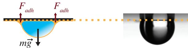
Fig. A: À gauche : schéma d'une goutte sur une LIS "tête en bas". Le ménisque d'huile, en dépression par rapport à l'extérieur, est à l'origine d'une force d'adhésion verticale sur les LIS. Si la goutte est plus petite que la longueur capillaire, elle est stable dans cette position. À droite : photo d'une goutte d'eau de 4  $\mu\text{L}$  suspendue sous une LIS.
