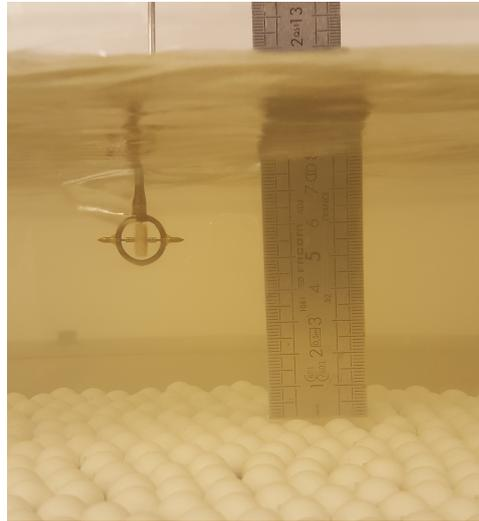
FIGURE 3.2 – Sonde Nixon streamflow dans le chenal. La mesure à partir de la règle permet de fixer la position verticale de la sonde afin d'établir le profil d'écoulement.
