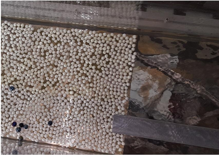
FIGURE 3.9 – Système de goulotte à surface libre faisant office de rampe pour les particules en mouvement afin de pénétrer sur la rugosité. La surface en scotch permet l'absorption du choc lors du dépôt de la bille et apporte du frottement (adhérence de la surface du scotch) qui permet à la bille de rouler et non glisser, et de prendre ainsi de la vitesse.
