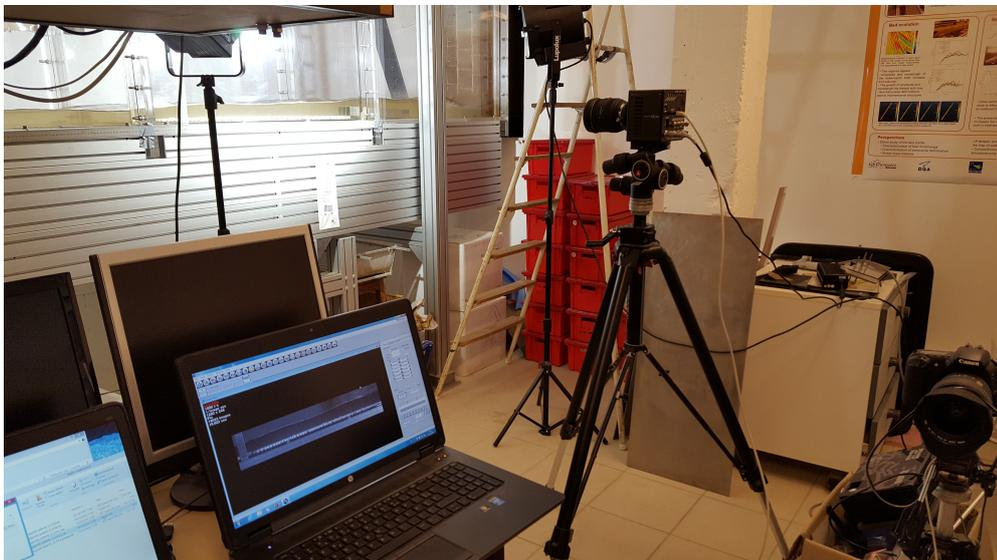
FIGURE 3.8 – Acquisition des données au sous-sol de l'IPR. La manipulation doit être éclairée au spot lumineux afin de compenser le faible temps d'ouverture de la caméra rapide.
