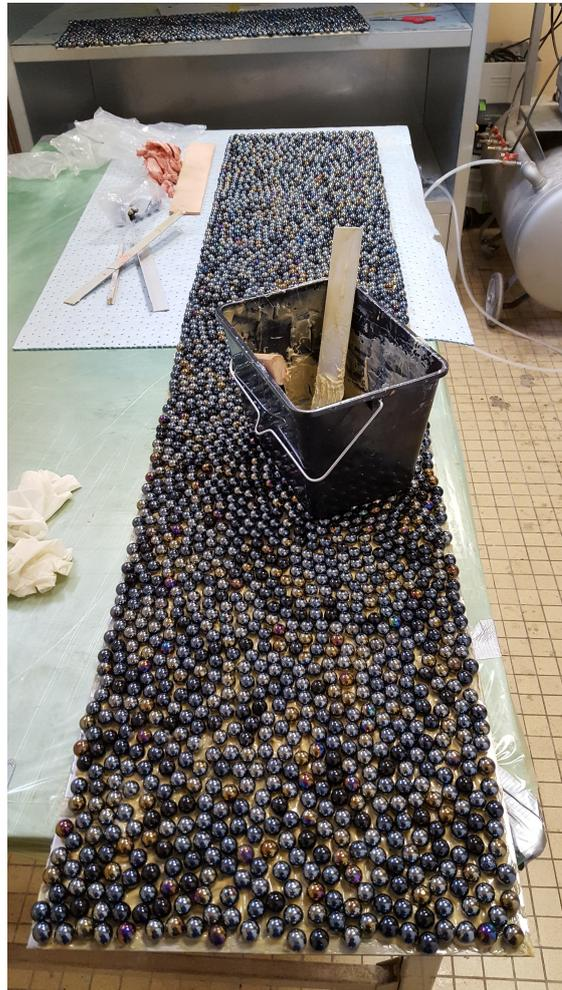
FIGURE 3.5 – Mise en place de la rugosité. Le collage permet d’obtenir une réalisation assez simple avec un contrôle sur cette rugosité. Ici, il s’agit de la rugosité composée des billes de diamètre  $d_B=1.6$  cm.
