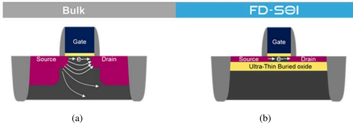
Figure 1. 7 Vue en coupe d'une structure MOS en (a) technologie bulk et (b) technologie FDSOI[18]
