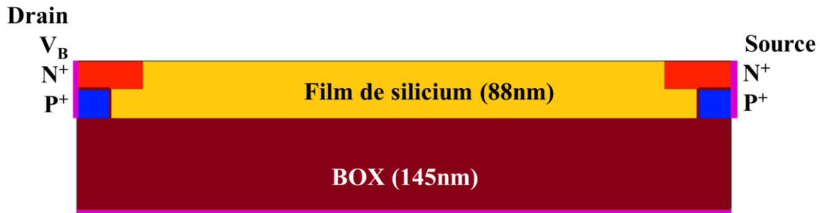
Figure 12: Structure utilisée pour la simulation du potentiel hors-équilibre.
