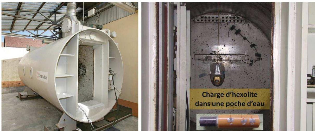
Figure II-1. Cuve de détonation de 9 m<sup>3</sup> (photographie de gauche). À l'intérieur, une charge d'hexolite RDX/TNT 60/40 (250 g) est suspendue dans une poche d'eau.
