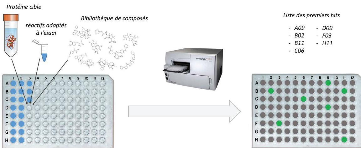
Figure I-3. Résumé des étapes du procédé HTS : les essais sont réalisés en microplaques, chaque puit contenant la protéine cible, un composé de la bibliothèque et les réactifs nécessaires à l'essai. Après incubation, un lecteur de plaques permet directement d'identifier les composés ayant interagi avec la protéine.
