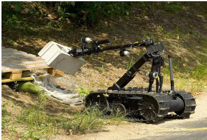
**Figure.1.7.** Robot à chenilles, LAND Robot TALON IV.
