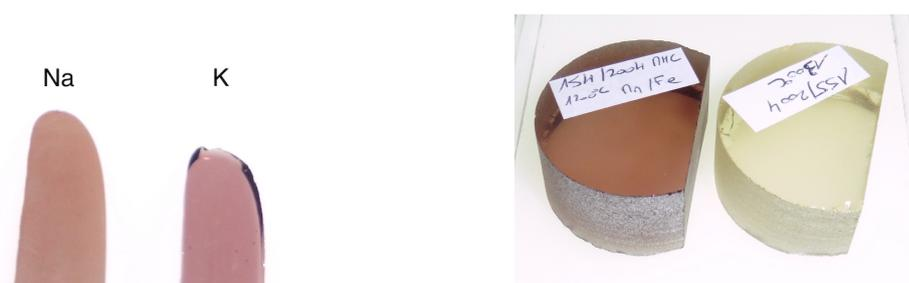
FIGURE 5.27 – Comparaison de deux verres modèles, dopés au manganèse, préparés en conditions oxydoréductrices neutres. Le verre de gauche a du sodium comme alcalin, le verre du droite du potassium.
