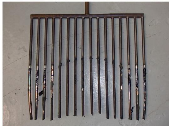
FIGURE 4.11 – Photos des râteaux utilisés pour la mesure de la forme des interfaces entre les fluides, après insertion dans le bain.
