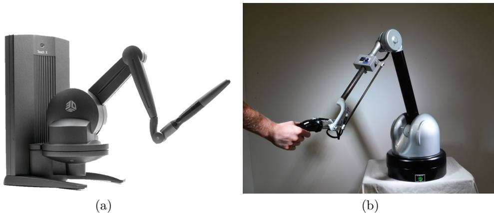
FIGURE 1.6 – (a) : l'interface haptique Touch X de 3D Systems, (b) : l'interface haptique Virtuose 6D de Haption
