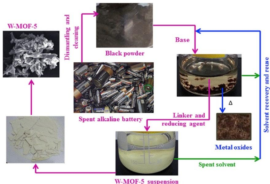
Figure 3-5 : Schéma de la méthode de recyclage par précipitation de MOF (©2018, Elsevier)
