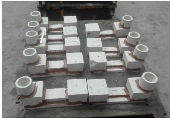
Figure 2.33 Coques prêtes à la coulée
