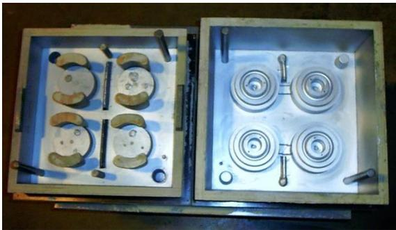
Figure 4.1 Caissons de fabrication de quatre pièces identiques
