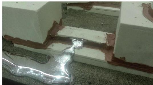
Figure 2.35 Percée de coulée épaisseur 5 mm #2
