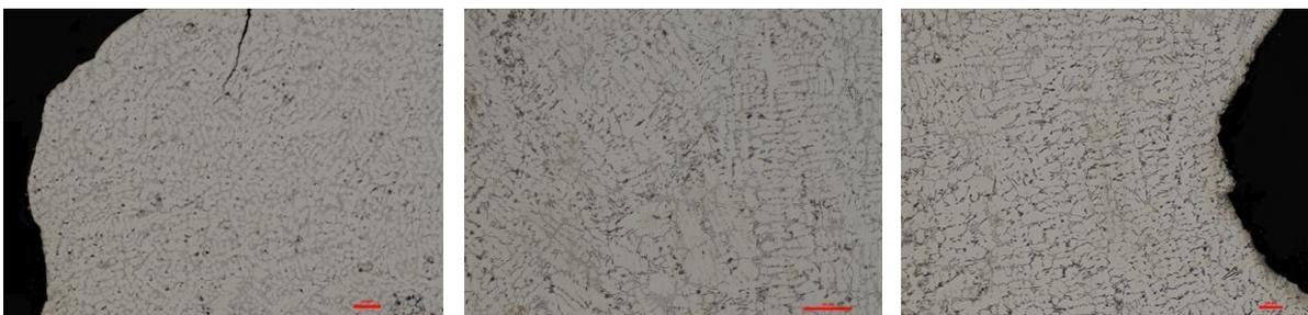
Figure 5.39 Prise d'image à X5 de la conception angle droit mono matériau a) coin extérieur, b) milieu, c) coin intérieur
