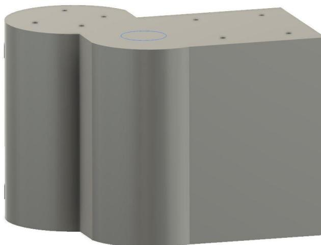
Figure 4.26 Réalisation du moule avec les opérations booléennes
