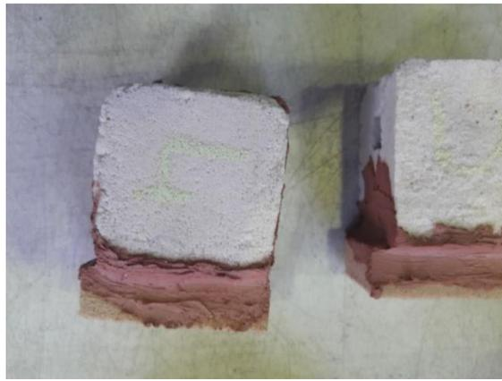
Figure 5.33 Assemblage des moules et colmatage des joints avec de l'argile
