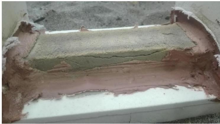
Figure A.34 Dégradation thermique de la coque 5 mm
