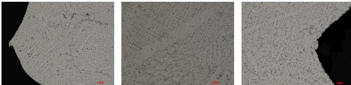
Figure 5.40 Prise d'image à X5 de la conception angle droit multimatériaux 2 a) coin extérieur, b) milieu, c) coin intérieur
