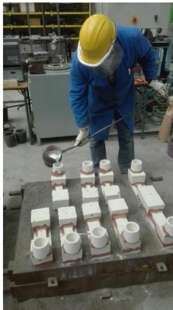
Figure 0.6 Coulée d'alliage d'aluminium dans un moule en sable
