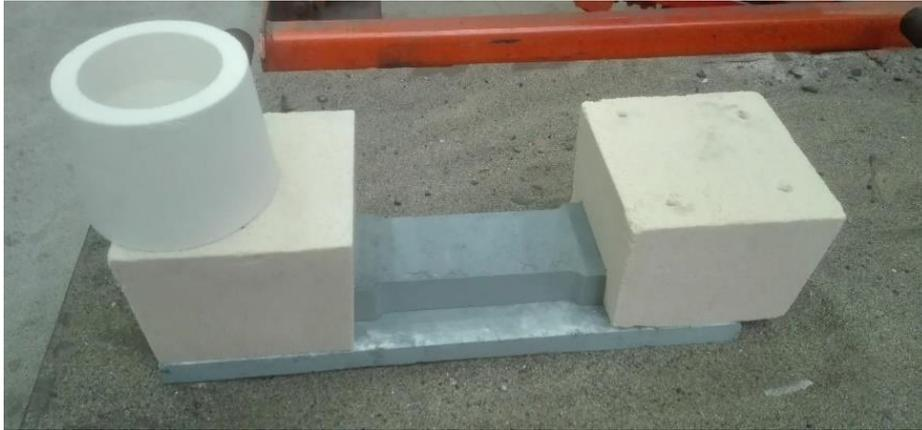
Figure 2.36 Moule en poudre d'aluminium
