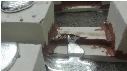
Figure 2.34 Percée de coulée épaisseur 5 mm #1
