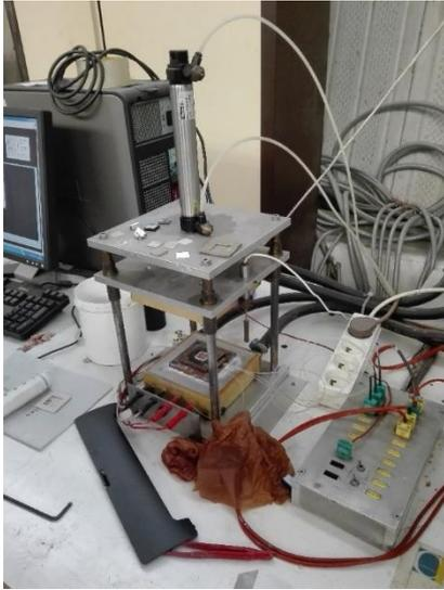
Figure A.4 Machine plaque gardée
