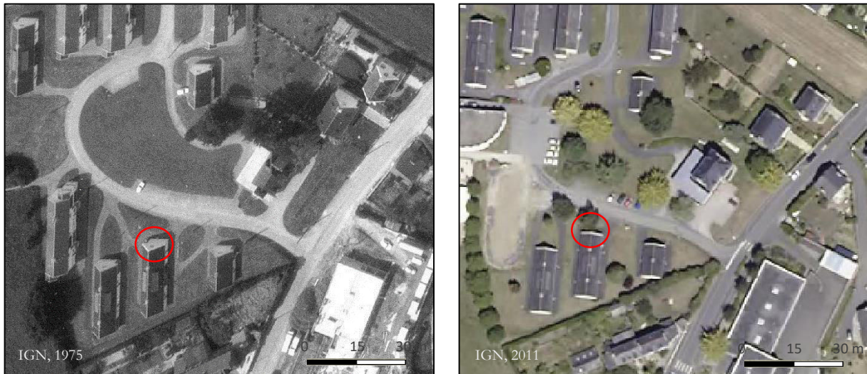
Fig. 99 : Exemple de problème de distorsion créé par l'angle de prise de vue des photographies (bourg de Pléneuf-Val-André entre 1975 et 2011).
