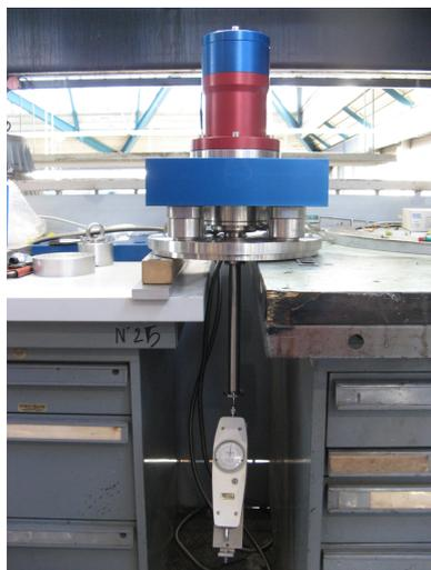
Figure 3.21 Contrôle de l'étalonnage des capteurs piézoétriques avec l'utilisation d'un dynamomètre
