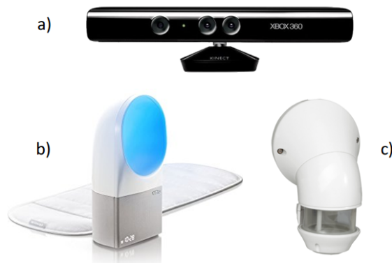
FIGURE 3.4 – Capteurs employés dans le système ambiant : a) Kinect, b) Capteur de Sommeil, c) Capteur de mouvement infrarouge
