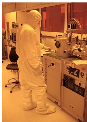
Figure IV-21- Bûti de pulvérisation cathodique assistée DC MP 300
