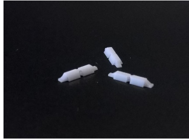
Figure IV-7- Filtres 2 pôles après calcination/ recuit
