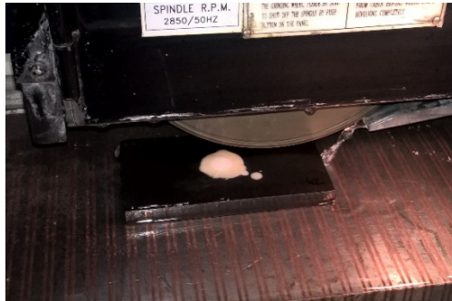
Elimination du reste du cylindre (vitesse de descente 8 \mu m)
