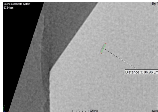
Figure IV-14- Fissure sur la pièce TM- DAR pure
