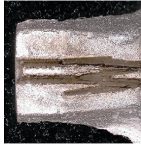
Figure IV-34- Rupture de la ligne centrale du filtre
