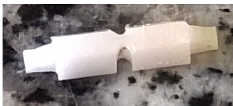
Filtre après décollage et nettoyage
