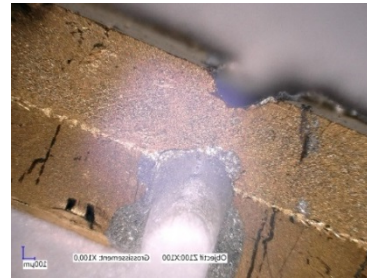
Figure IV-29- Manque de métallisation au niveau des congés et des iris
