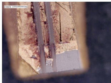
Figure IV-30- Utilisation de la laque d'argent pour couvrir les zones non métallisées
