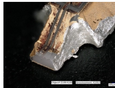
Figure IV-31- Décollement de la métallisation
