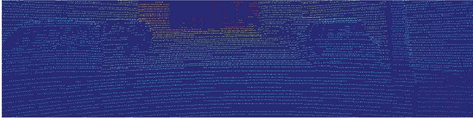
FIGURE 6.2 – Un exemple de scan LiDAR artificiellement densifié où les pixels non observés par le LiDAR ont été encodés avec des 0. La colormap va de 0 mètre (en bleu) à 80 mètres (en rouge)
