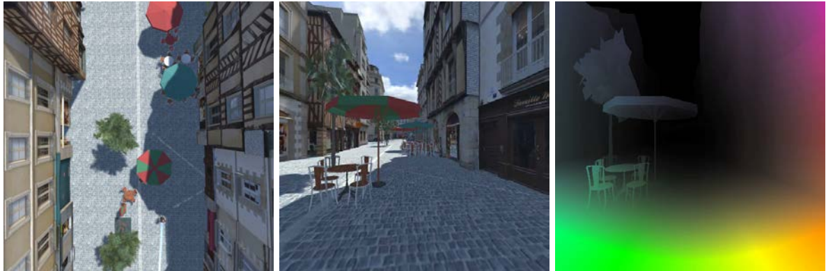
Figure 4 – Exemple de navigation par flux optique. (gauche) Vue de dessus de la scène et de la trajectoire de l'agent. (milieu) Scène perçue du point de vue de l'agent. (droite) Flux optique perçut par l'agent.
