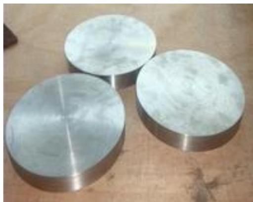
Figure II- 19 : Echantillons d'alliage CoCrMo usinés en disques de 6 mm d'épaisseur.
