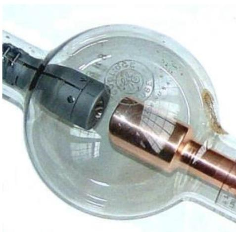
Les deux métaux couramment utilisés pour l'anode sont le cuivre, qui produit des rayons X de longueur d'onde  $\lambda = 1,54 \text{ \AA}$  et le molybdène,  $\lambda = 0,709 \text{ \AA}$ . Comment choisir le matériau ?
