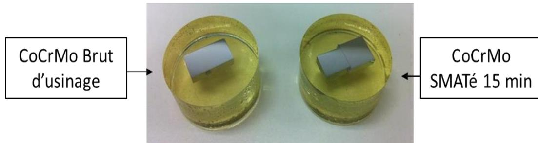
Figure III-51 : Echantillons préparés pour observation EBSD
