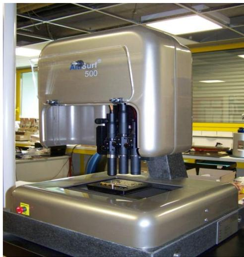
Figure 1 : Altisurf utilisé lors des mesures de rugosité de l'alliage CoCrMo avant et après traitement SMAT
