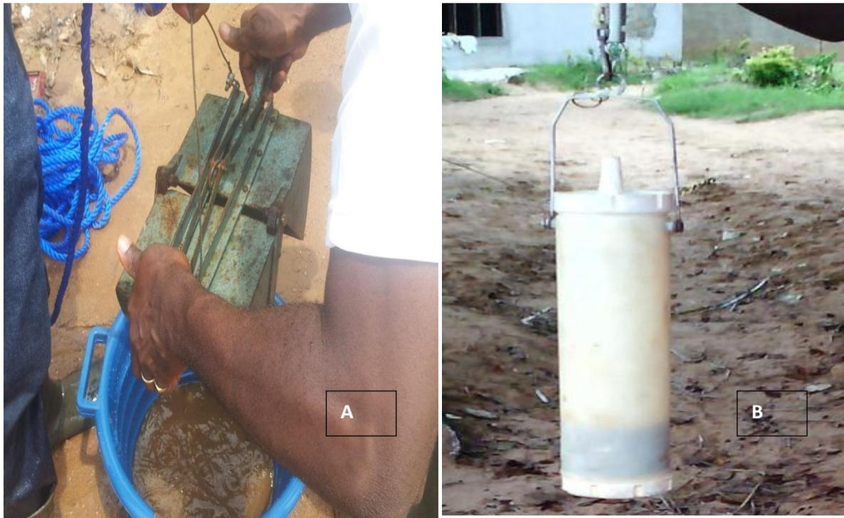
**Figure 8 : Matériel d'échantillonnage: (A= benne à sédiment EKMAN; B=Bouteille hydrologique) (Photo : COULIBALY Kalpy)**
