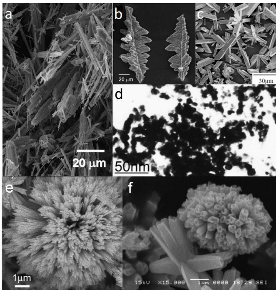
**Figure I.12 : Morphologies d'oxalate d'étain : (a) aiguilles<sup>128</sup> (b) feuilles<sup>113</sup> (c) prismes<sup>125,129</sup> (d) nanoparticules sphériques<sup>130</sup> (e) « fleurs »<sup>109</sup> (f) tubes submicroniques<sup>124</sup>**
