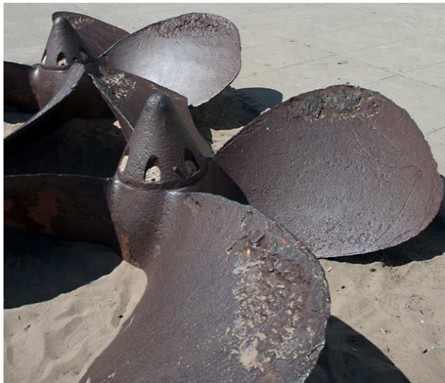
FIGURE .2 – Exemple d'endommagement d'une hélice par cavitation, http://blog.pes-solutions.com/pes-201-boat-propeller-cavitation-and-repair/
