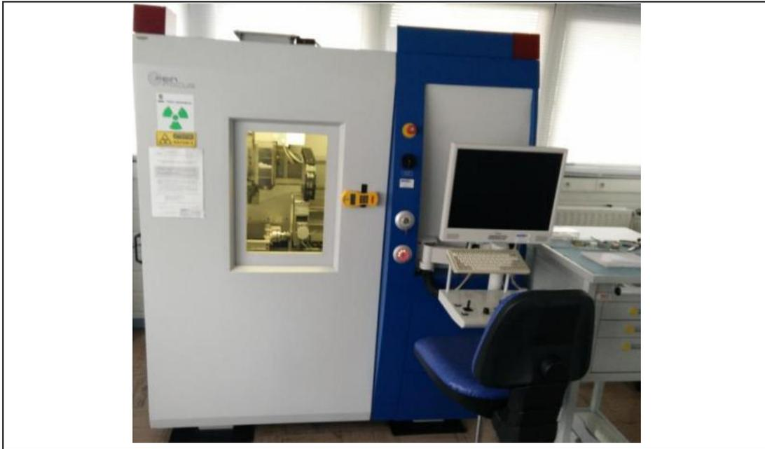
**Figure 2.11 : Machine de radiographie FeinFocus FOX-160.25.**
