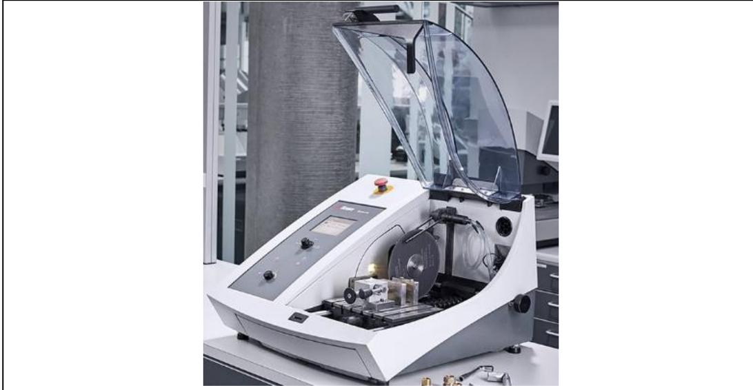
**Figure 2.14 : Machine de tronçonnage Struers Secotom.**
