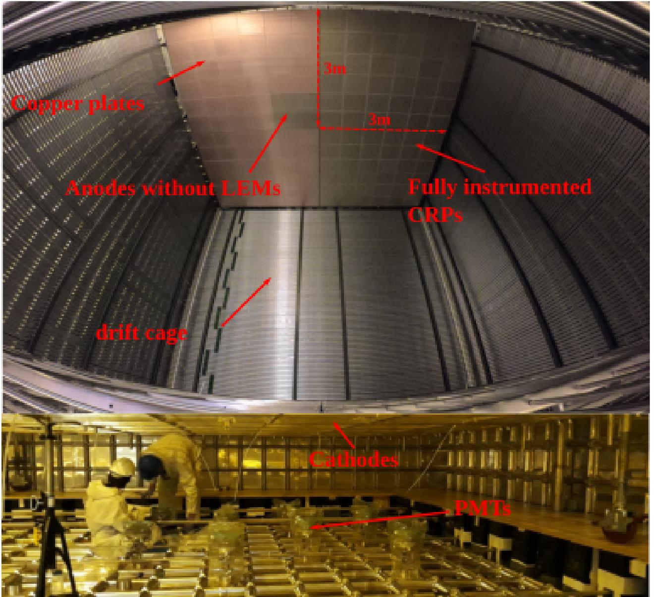
**FIGURE 3.9** – Photographies de l’intérieur du démonstrateur de  $6 \times 6 \times 6 \text{ m}^3$  (mars 2019). On y voit, en haut, les quatre CRPs dont deux sont instrumentés avec des LEMs et d’anodes, un non instrumenté et un muni de quatre anodes sans LEMs. Ce dernier pourra étudier la collection de charges sans amplification et ainsi avoir une mesure direct de l’efficacité d’extraction sur la charge lue. En bas sont visibles les cathodes et les PMTs, alors en cours d’installation.
