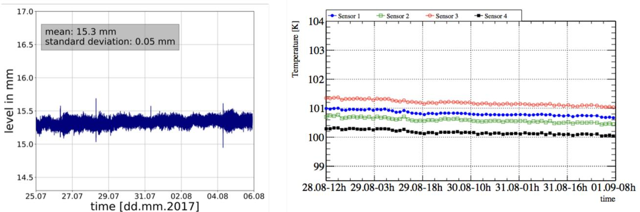
**FIGURE 5.11** – Variation de température (droite) et de niveau d’argon (gauche) dans le  $3 \times 1 \times 1 \text{ m}^3$  durant une semaine. Les graphiques viennent de l’article de 2018 du  $3 \times 1 \times 1 \text{ m}^3$  [2].
