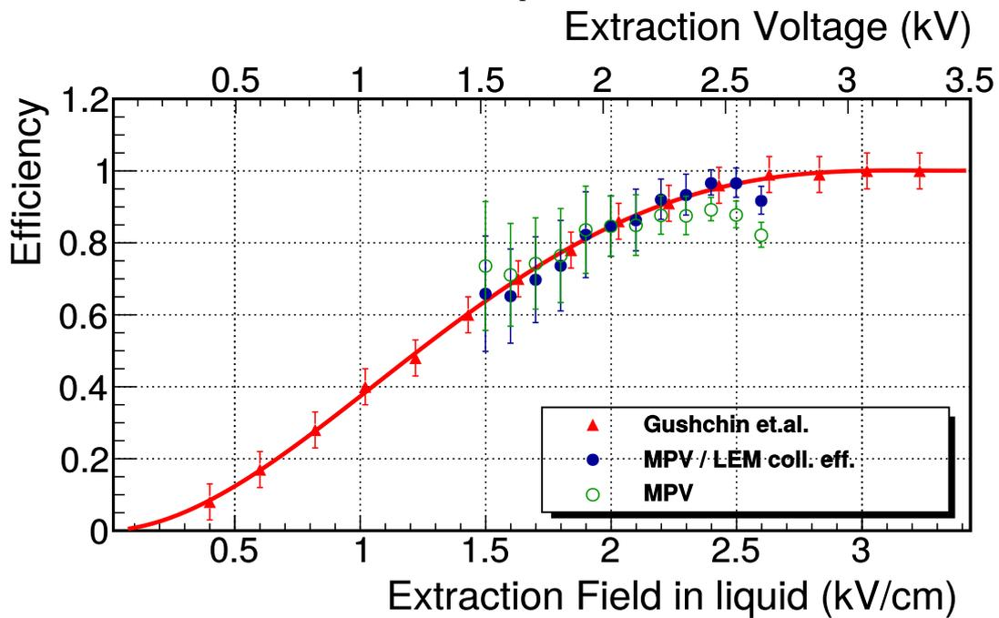
(b) MPV et MPV divisée par l'efficacité de collection du LEM, normalisées à l'efficacité d'extraction mesurée dans [3] à  $2 \text{ kV cm}^{-1}$ .
