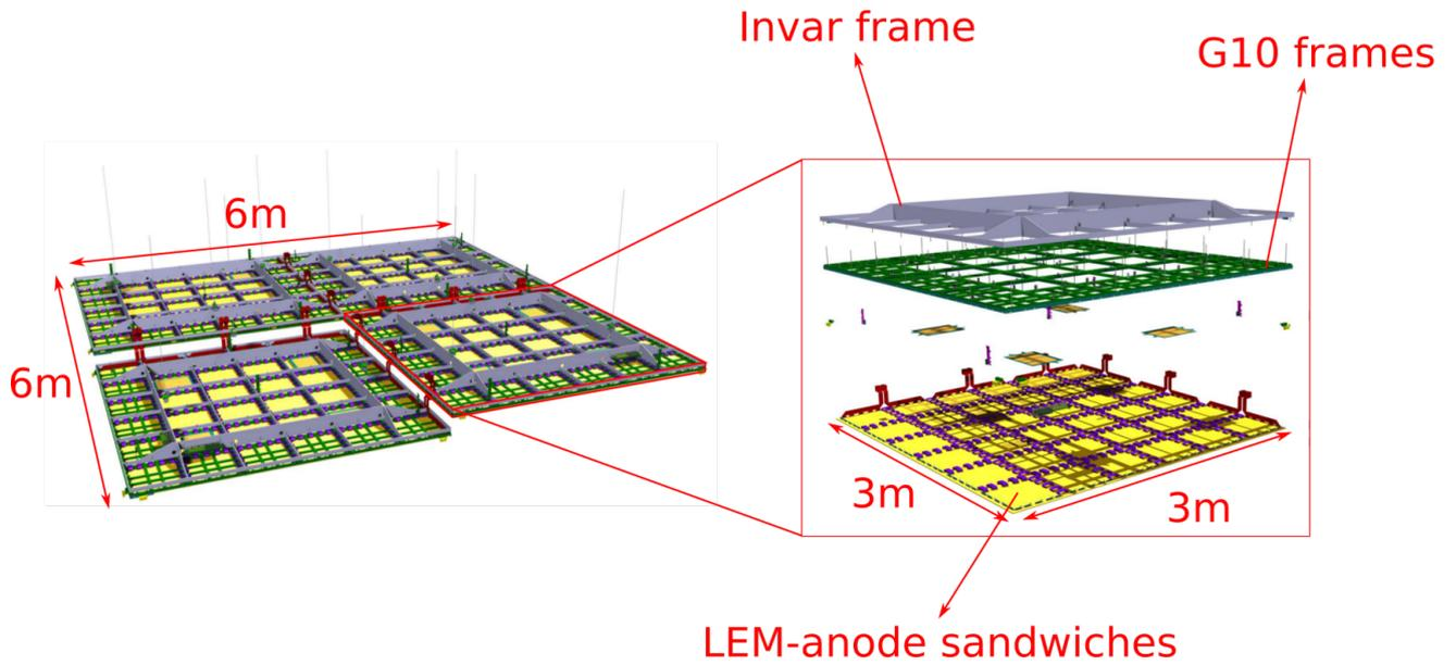
FIGURE 3.7 – Schéma des quatre CRPs du démonstrateur de  $6 \times 6 \times 6 \text{ m}^3$ .
