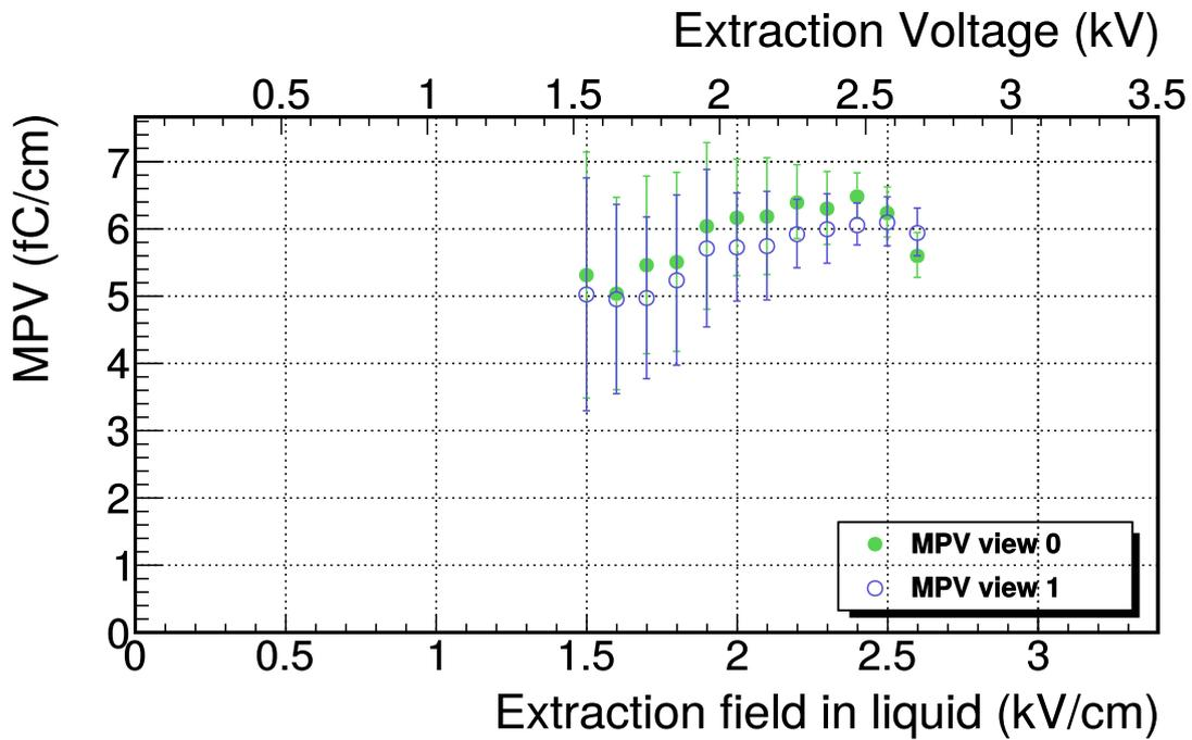
(a) MPV en fonction du champ d'extraction dans le  $3 \times 1 \times 1 \text{ m}^3$ .
