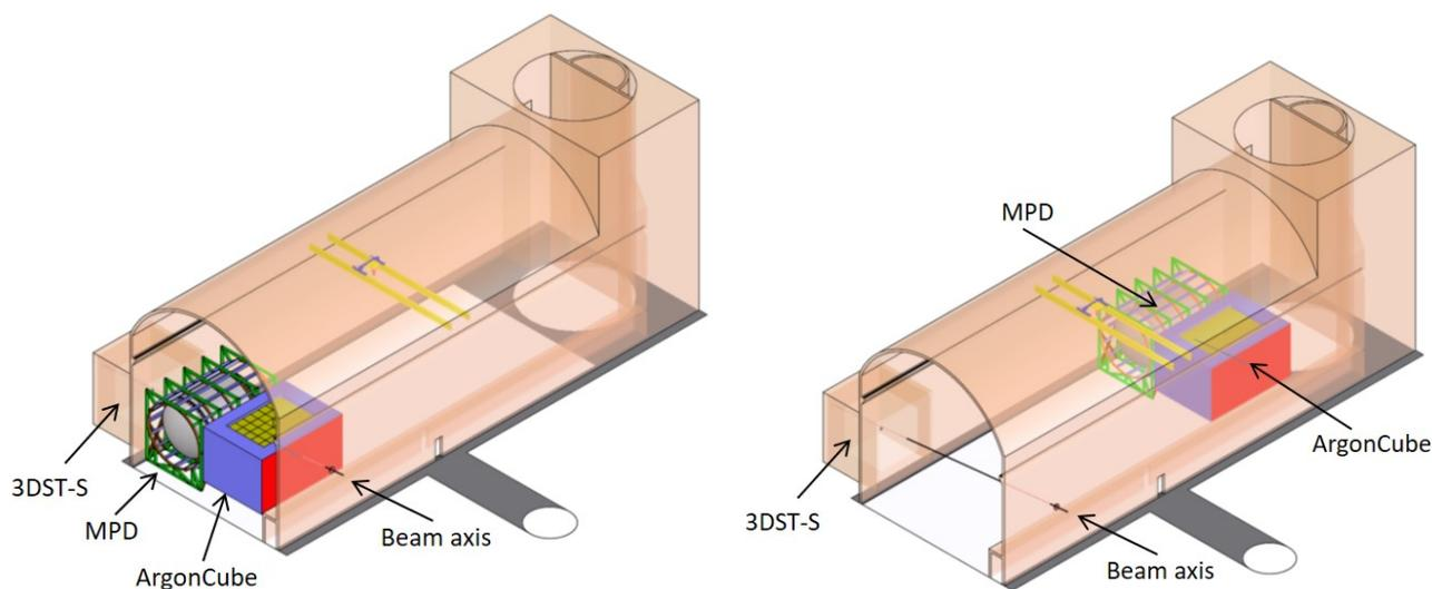
**FIGURE 2.8** – Schéma du détecteur proche de DU $\nu$ E. Les deux premiers éléments, une LArTPC et une Chambre à Projection Temporelle (TPC) à argon gazeux, sont mobiles sur un axe perpendiculaire au faisceau.
