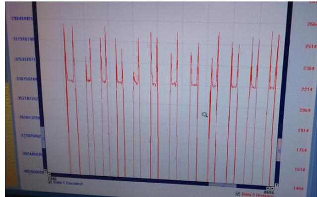
(b) Représentation brute des données de mesure d'un LEM avec la technique CCI. Les grands pics sont coupés à l'analyse.
