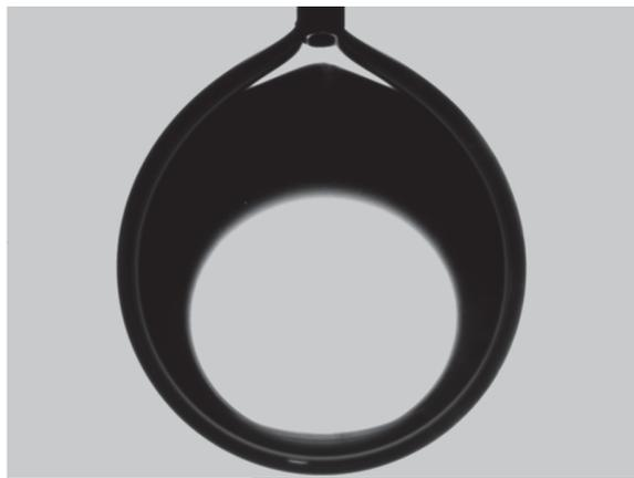
*Figure 46. Image numérique pour la mesure de la tension interfaciale d'une huile.*
