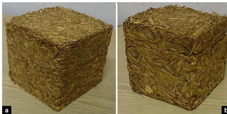
FIGURE 5.18 – Photos des composites (a) n°19 et (b) n°20, fabriqués avec de la paille de blé et de l'extrait de rafles de maïs.
