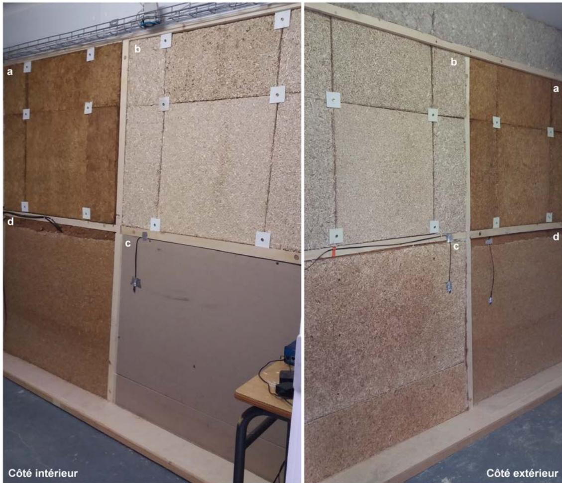
FIGURE 6.13 – Photographies intérieur et extérieur de la paroi montée dans la chambre bi-climatique : (a) panneau de paille de colza traitée, (b) panneau bi-couche, (c) solution retenue par le projet ISOBIO et (d) béton terre-chanvre (MAZHOUH [2017]), avant l'application des enduits et l'ajout de la couche de rafles de maïs pour la cellule (b).
