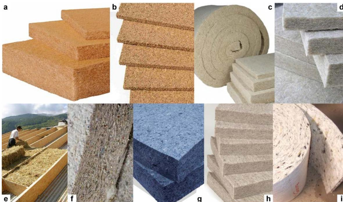
FIGURE 1.9 – Isolants naturels : (a) Panneaux de fibre de bois, (b) Panneaux de liège, (c) Panneaux et rouleau de laine de chanvre, (d) Panneaux de laine de lin, (e) Bottes de pailles, (f) Panneaux de ouate de cellulose issue du recyclage du papier, (g) Panneaux de ouate de cellulose issue du recyclage du tissu, (h) Panneaux de laine de mouton et (i) Rouleau de plumes de canard.
