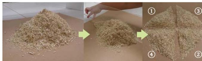
FIGURE 2.5 – Méthode d'échantillonnage.
