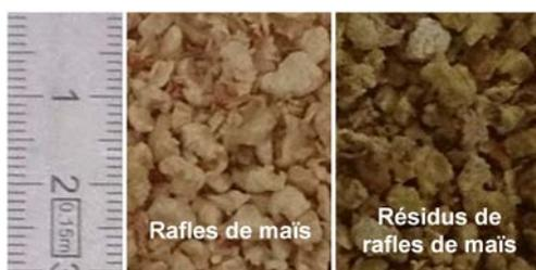
FIGURE 4.14 – Photographies des rafles de maïs avant et après l'extraction des solubles avec une solution de silicate de sodium à 5 %.
