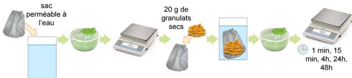
FIGURE 2.10 – Protocole de mesure de l'absorption d'eau.
