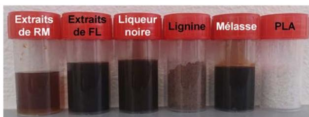
FIGURE 4.20 – Différents liants sélectionnés (RM : Rafles de maïs et FL : Fines de lin).
