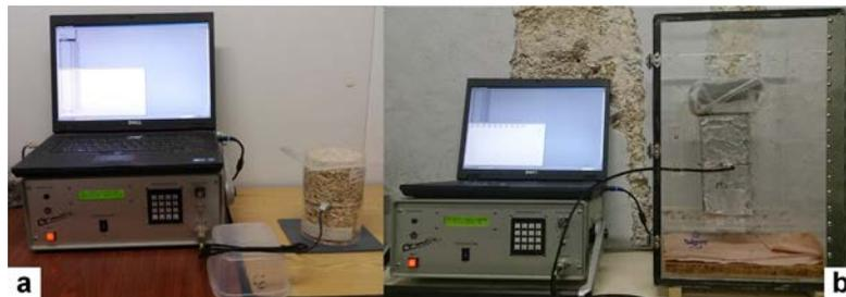
FIGURE 2.11 – Dispositif expérimental pour la mesure de la conductivité thermique des granulats (a) et des composites (b).
