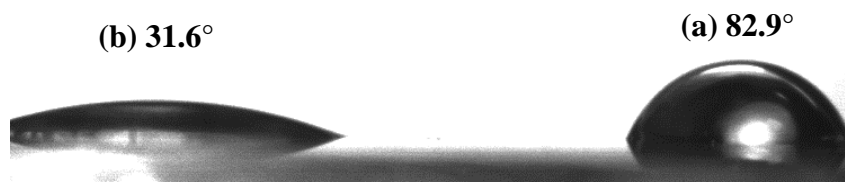
Figure 37: mesures de l'angle de contact des surfaces Au (a) et COOH-Au (b)
