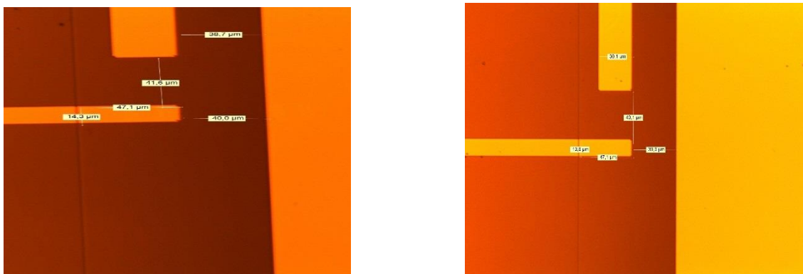
Figure N° 05 : caractérisation des électrodes par microscope optique
