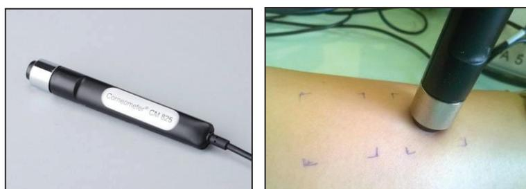
*Figure 33. Corneometer CM825 et méthode d'application de la sonde sur l'épiderme*
