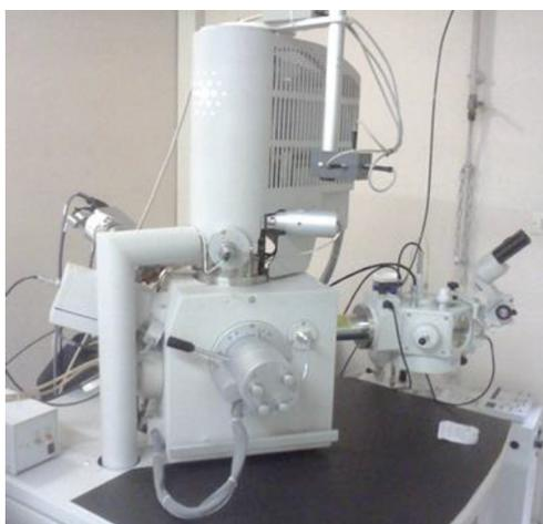
Figure 20. Microscopie électronique à balayage FEI Quanta 250 FEG (CT $\mu$ , la DOUA, Villeurbanne)
