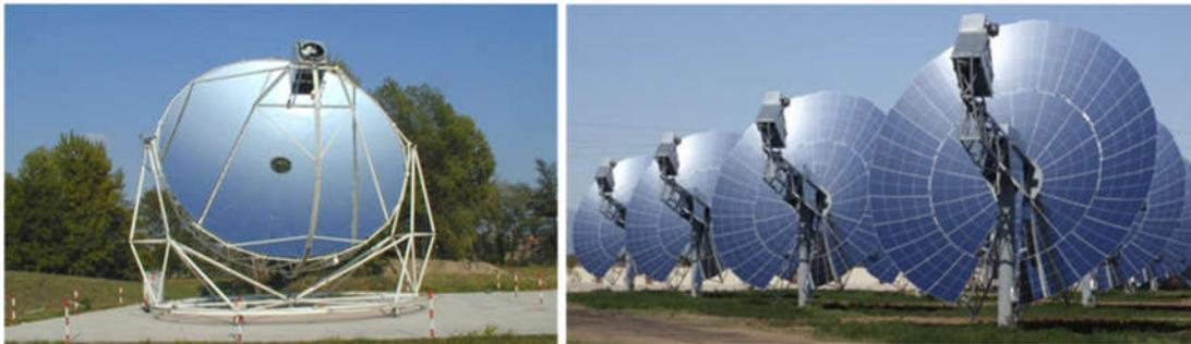
**Figure 1-7 - Parabole solaire montées avec génératrice Stirling.
