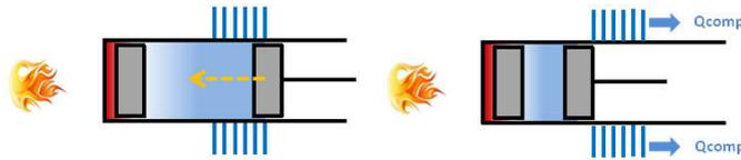
Figure 1-9 - Schématisation d'une compression isotherme
