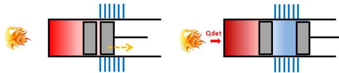
Figure 1-11 -- Schématisation d'une détente isotherme
