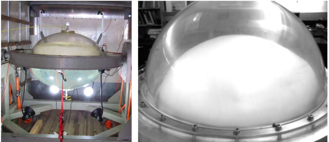
FIGURE 1.14 – Dispositif expérimental pour le ballottage dans un réservoir à membrane installé dans un camion à gauche et exemple de surface de la membrane à droite [21].
