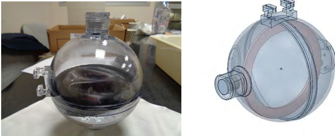
FIGURE 7.1 – Photo du réservoir à membrane à gauche et schéma du réservoir avec baffle anti-ballonnement à droite.
