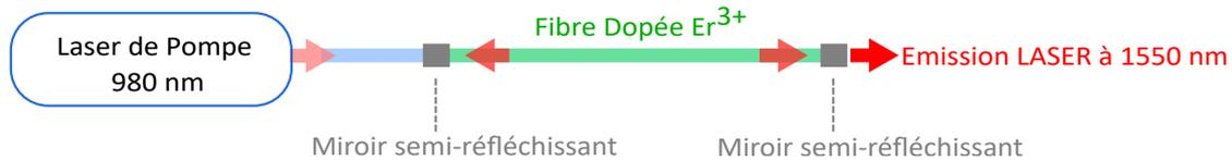
FIGURE 2.3: Schéma de l'architecture d'une cavité LASER fibrée linéaire. Des miroirs semi-réfléchissants forment la cavité, une fibre dopée erbium joue le rôle du milieu amplificateur et une source extérieure assure le pompage optique.
