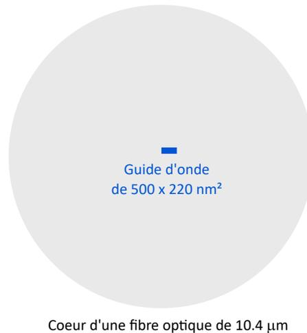
FIGURE 3.2: Problématique de couplage d'une fibre optique monomode type *SMF28* dont le cœur a un diamètre de  $10.4\ \mu\text{m}$  à un guide d'onde SOI ( $w = 500\ \text{nm}$ ,  $h = 220\ \text{nm}$ ).
