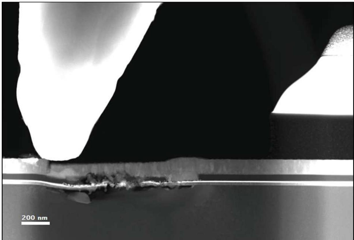
Figure VI-7: Image STEM-HAADF de la lame TEM après l'opération de RESET.
