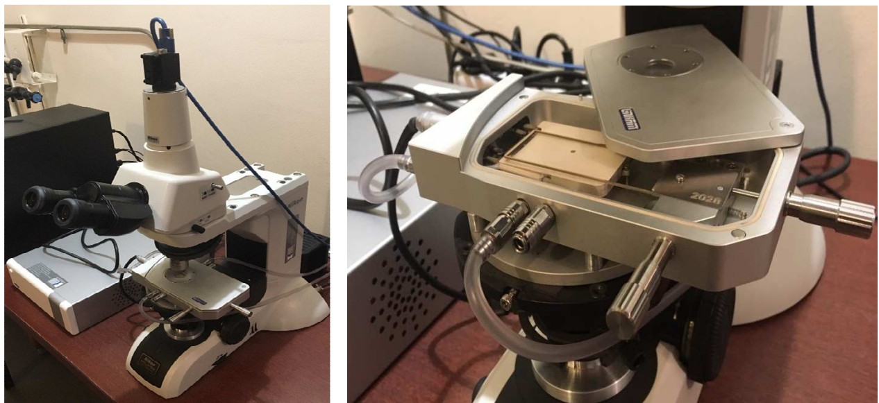
Figure 24 – A gauche le microscope optique à lumière polarisée et à droite le support d'échantillon avec platine chauffante.
