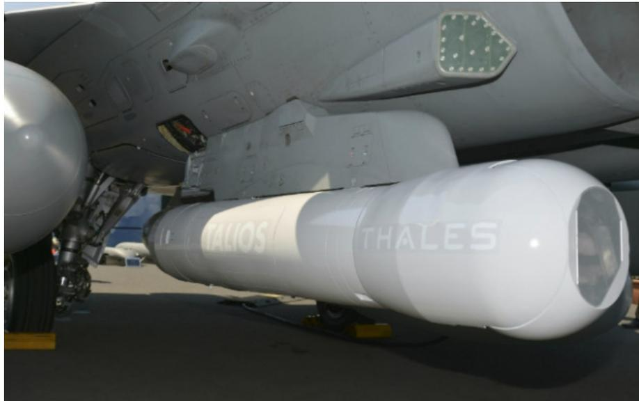
FIGURE 1.1 – Photo d'un PoD de désignation laser fixé sous un avion de chasse de type Rafale
