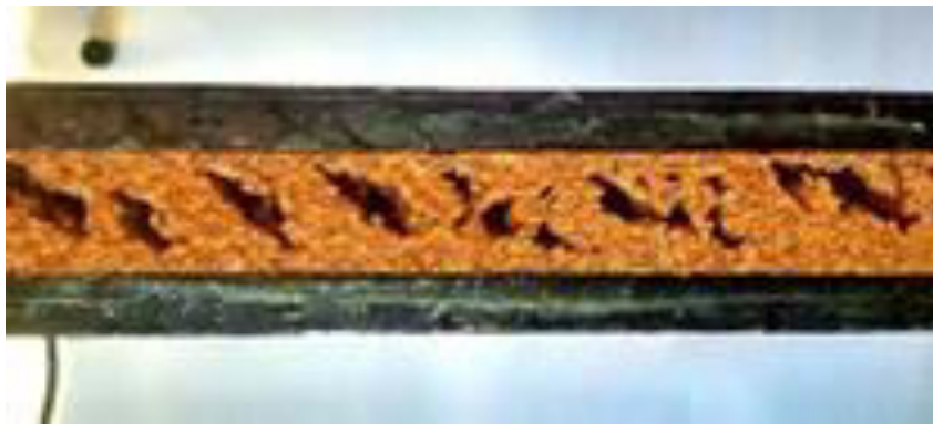
Figure 2.14. Exemple de rupture en cisaillement des âmes.
