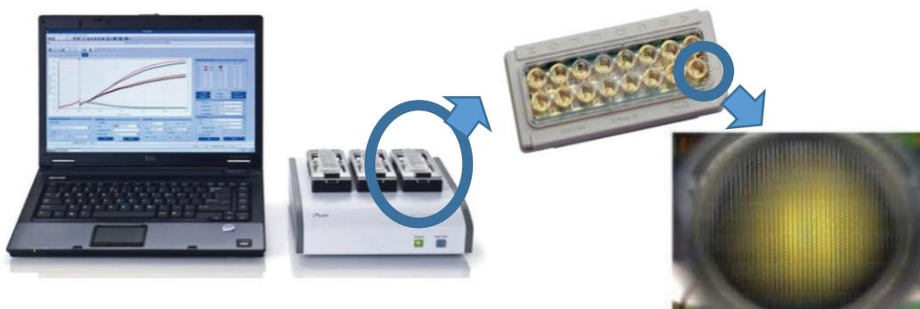
Figure 89 : Appareillage pour la méthode RTCA (De gauche à droite : appareillage électronique, plaque contenant les micro-puits, et observation d'un puits et de ses électrodes.
