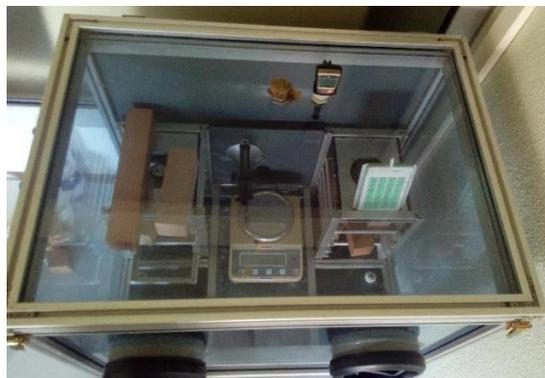
Figure 51 : Enceinte climatique de régulation d'humidité initiale
