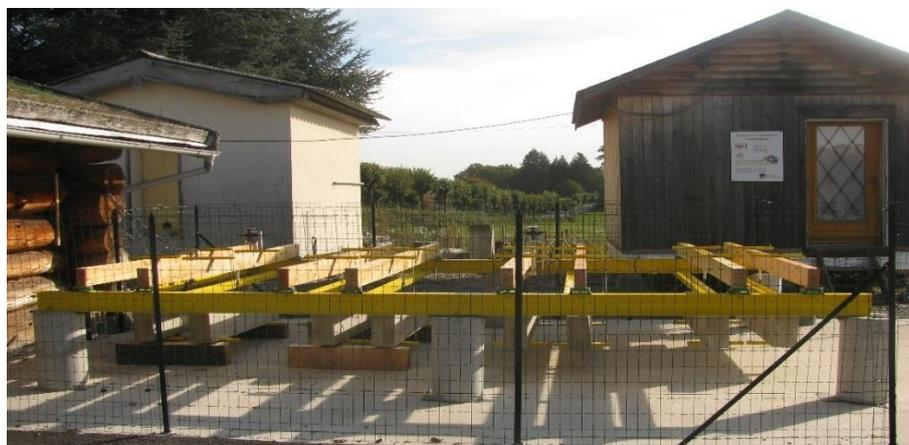
Figure 114 : Banc de flexion 4 points en extérieur
