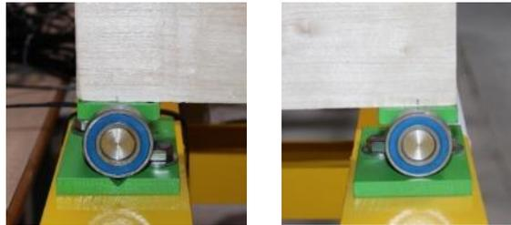
Figure 111 : Appui bloqué (à gauche) et appui libre (à droite)
