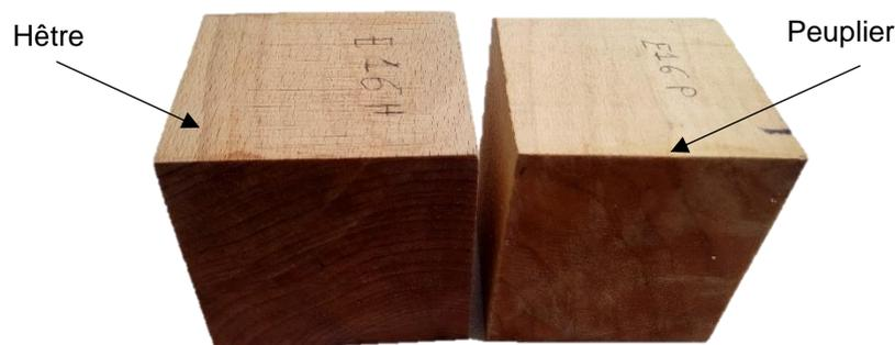
Figure 44 : Échantillons pour essais de diffusion transversale
