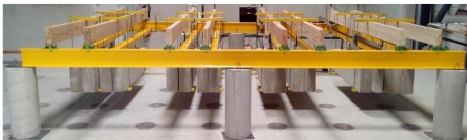
Figure 113 : Banc de flexion 4 points en intérieur
