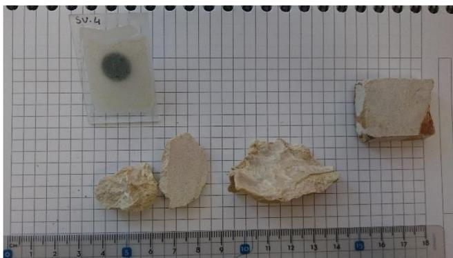
Figure II.12 : Photo de l'échantillon et de la lame mince non couverte de Sa-a.
