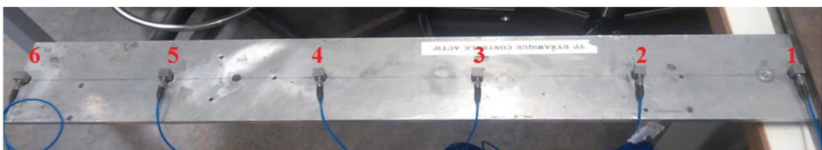
FIGURE 2.4. *Emplacement des accéléromètres sur la poutre.*
