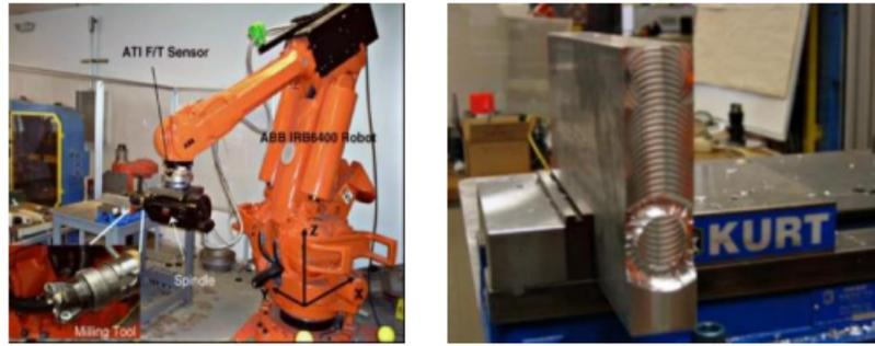
FIGURE 1.9. Marquage important de la pièce dû aux vibrations du manipulateur [Pan et al., 2006]
