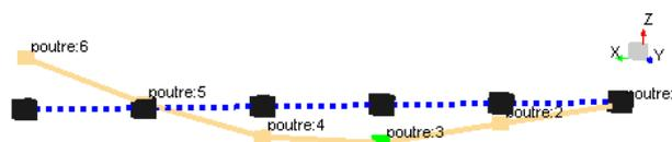
FIGURE 2.7. *Déformée modale du deuxième mode propre de la poutre.*
