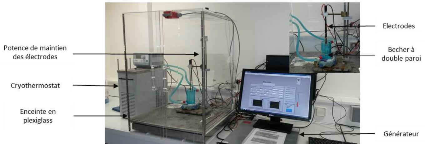
Figure 35 : Photographie de la nouvelle station d'anodisation. L'insert représenté un agrandissement de la zone de réaction (béccher à double paroi).
