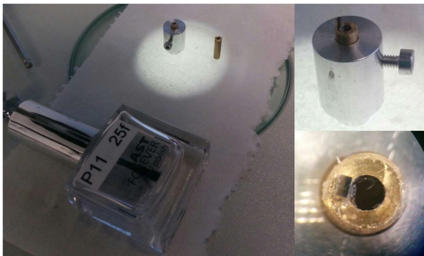
Figure 58: Fixation, à l'aide de vernis à ongles, de l'échantillon (900 x 1500 x 500 \mu m) sur le support métallique pour l'examen en XRF.
