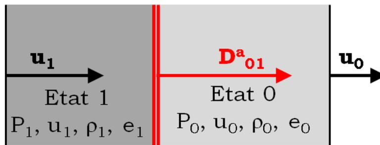
Figure 29. Illustration de l'évolution des propriétés de la matière au cours du passage du choc.  $P_i$  est la pression,  $u_i$  est la vitesse matérielle,  $\rho_i$  est la masse volumique et  $e_i$  est l'énergie interne massique, l'indice 0 correspond à l'état initial avant le passage du choc tandis que l'indice 1 fait référence à l'état choqué après le passage du choc.  $D_{01}^a$  correspond à la célérité absolue de l'onde de choc qui fait passer le milieu de l'état 0 à l'état 1.
