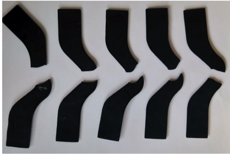
Figure 5.5 – Fissures déchirement angulaire du mélange témoin N330
