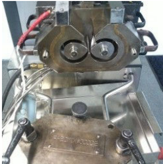
Figure 2.15 – Mélangeur interne HAAKE Rheomix (300 cm 3 ) du LRCCP
