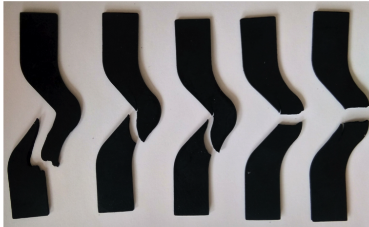
Figure 5.6 – Fissures déchirement angulaire du mélange rCB Vapo_rCB_N330
