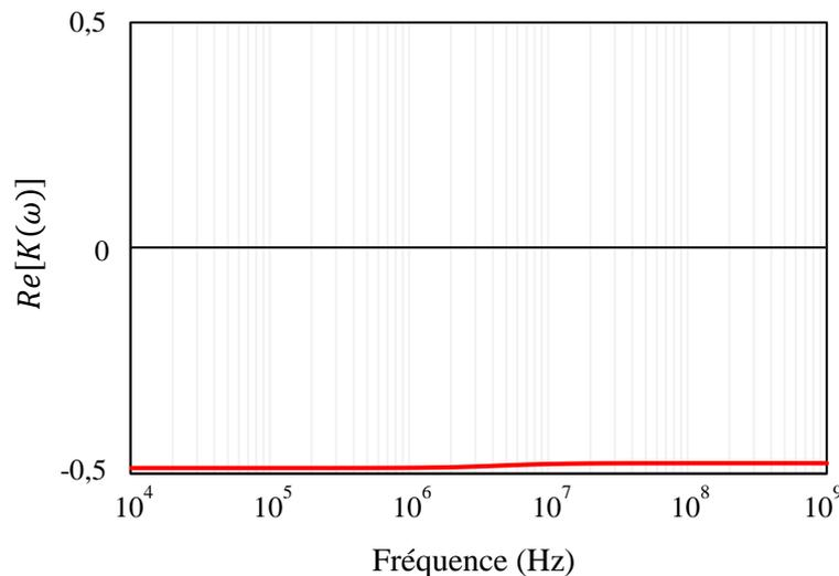
**Figure. 70** Réponse diélectrophorétique théorique d'une bille de polystyrène de diamètre 12  $\mu\text{m}$ , suspendue dans un milieu possédant une permittivité  $\epsilon_m = 78\epsilon_0$  F/m et une conductivité  $\sigma_m = 20$  mS/m.
