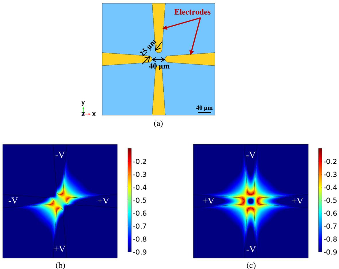
**Figure. 42** (a) Géométrie du quadripôle. Profil de l'intensité du champ électrique pour la structure à quatre électrodes à une altitude  $z = 5 \mu\text{m}$  : (b) dont deux électrodes adjacentes possèdent la même polarité, (c) dont les électrodes à  $180^\circ$  sont mises à la même polarité.
