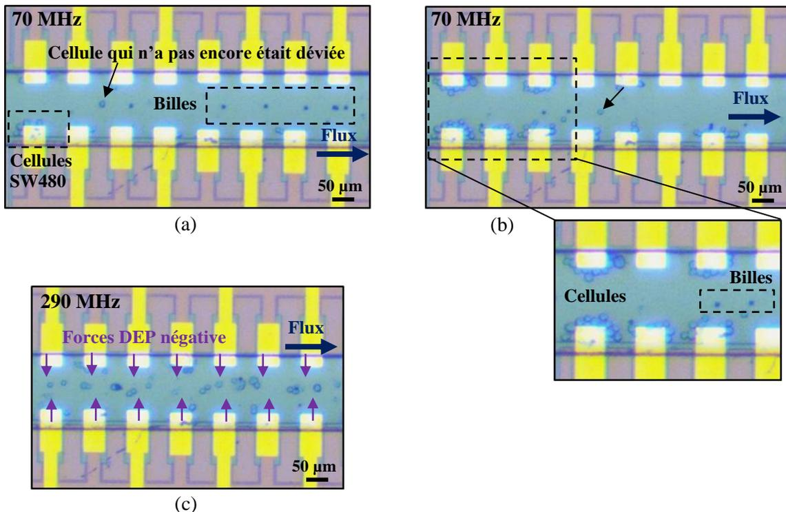
**Figure. 102** (a) et (b) Séparation des cellules SW480 et des billes de polystyrène en flux sous l'action d'un signal RF à 70 MHz ; les cellules et les billes réagissent respectivement en DEP positive et DEP négative, (c) cellules SW480 et billes de polystyrènes soumises à des forces de DEP négative à 290 MHz, se déplaçant au centre du cytomètre avec le flux imposé dans le canal.
