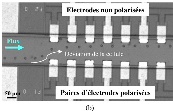
**Figure. 100** (a) Distribution du champ électrique normalisé, généré par le cytomètre dont un seul réseau d'électrodes est polarisé avec un signal RF à 300 MHz pour une tension  $4 V_{pp}$ , (b) superposition d'images montrant le changement progressif de la trajectoire d'une cellule individuelle en flux réagissant en DEP négative, du gradient de champ électrique.
