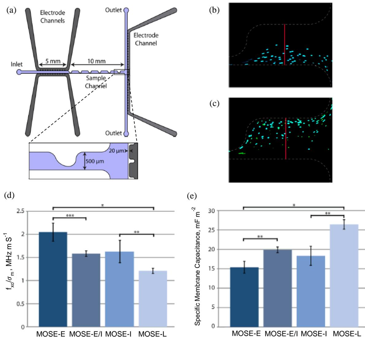
**Figure. 29** (a) Vue de dessus du dispositif de caractérisation DEP, (b) cellules réagissant en DEP négative en se déplaçant vers la moitié inférieure du canal, (c) cellules réagissant en DEP positive en se déplaçant vers la moitié supérieure du canal, (d) spectre de la fréquence de transition pour les quatre stades de cellules malignes MOSE (n=3), (e) spectre de la capacité membranaire spécifique pour les quatre stades de cellules malignes MOSE (n=3) [96].
