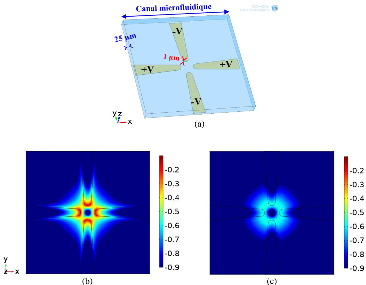
**Figure. 44** (a) Structure à quatre électrodes fines permettant l'application du signal de DEP. Vue de dessus de la configuration du champ électrique généré aux altitudes : (b)  $z = 5\ \mu\text{m}$ , (c)  $z = 13\ \mu\text{m}$ .
