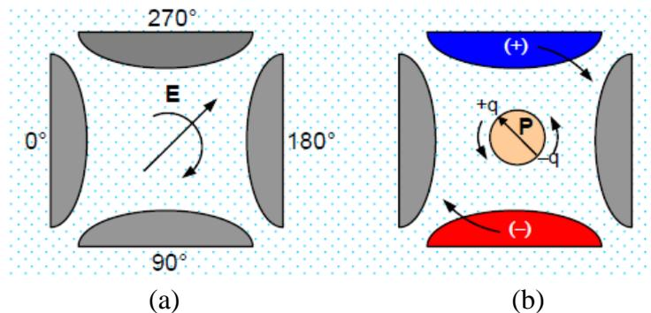
**Figure. 6** (a) Un champ électrique rotatif généré par un dispositif à quatre électrodes alimentées par des signaux alternatifs déphasés de  $90^\circ$ , (b) en fonction de l'angle de phase entre le moment dipolaire induit  $P$  et le champ, un couple impose à la particule un mouvement de rotation dans le même sens ou en sens inverse au champ [37].
