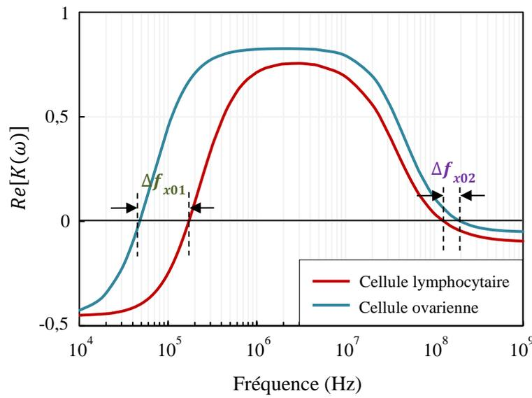
**Figure. 26** Réponses diélectrophorétiques théoriques de cellules de lymphocyte et d'ovaire de petits rongeurs, possédant des propriétés diélectriques et paramètres morphologiques différents [77], [86], mises en suspension dans un milieu de conductivité  $\sigma_m = 0,02$  S/m.
