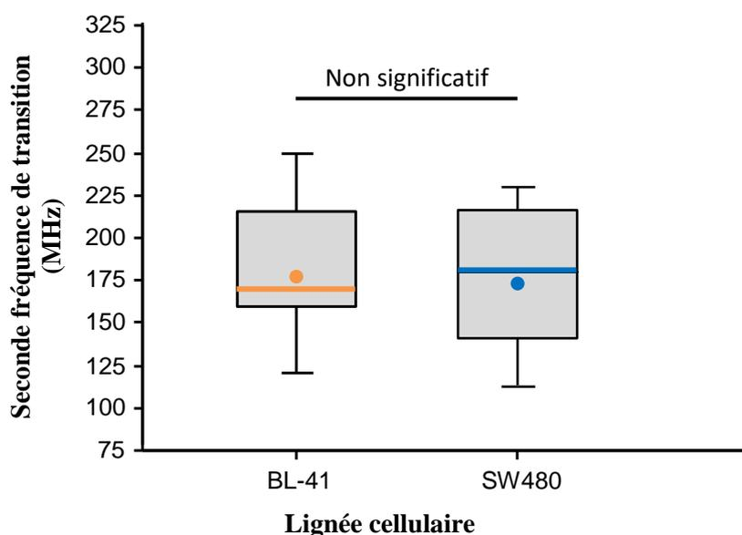
**Figure. 92** Boîtes à moustaches des fréquences de transition  $f_{x02}$  mesurées pour 52 cellules BL-41 et 51 cellules SW480.
