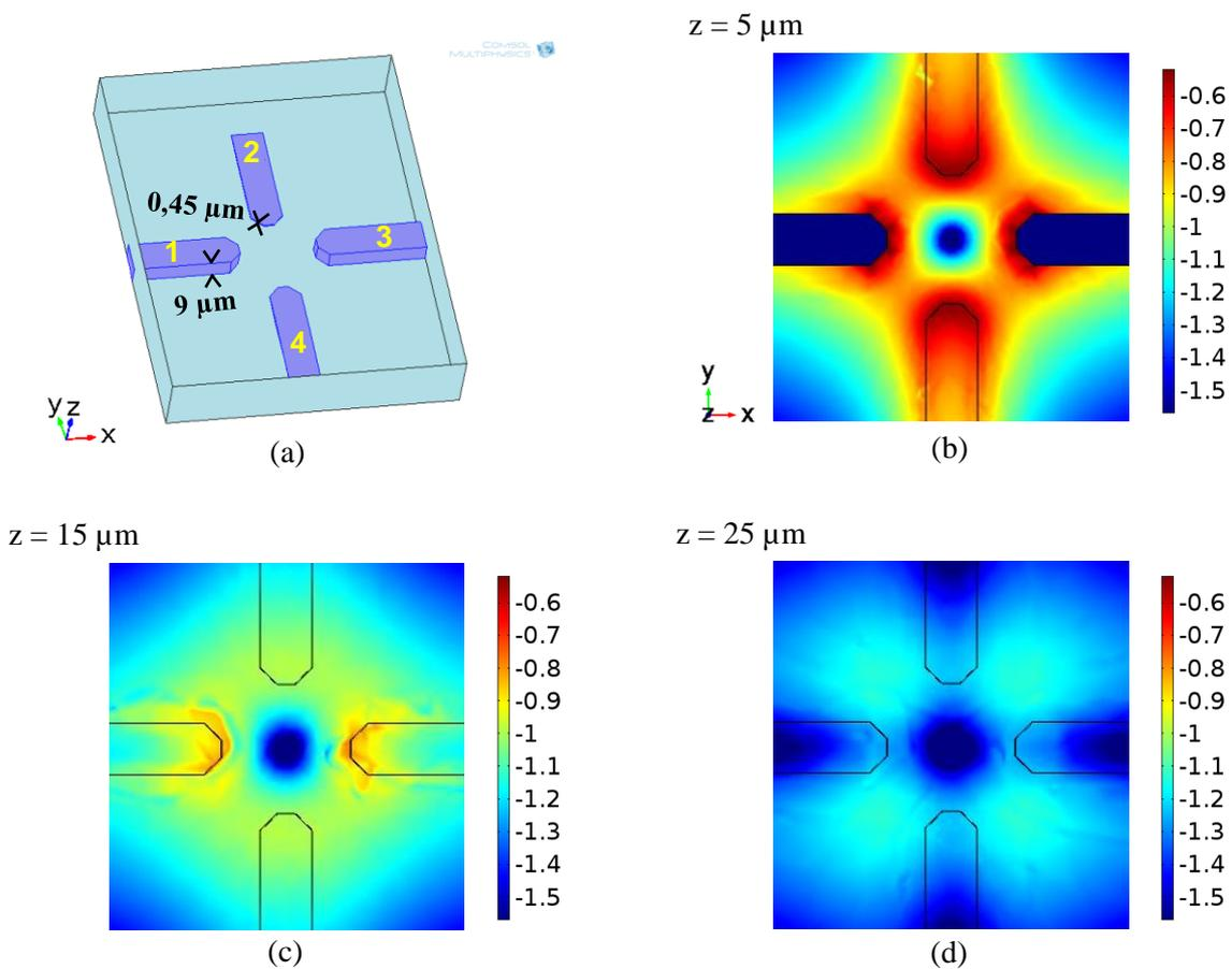
**Figure. 55** (a) Structure du quadripôle combinant une paire d'électrodes épaisses et une paire d'électrodes fines. Distribution du champ électrique généré par la structure du quadripôle aux altitudes : (b)  $z = 5 \mu\text{m}$ , (c)  $z = 15 \mu\text{m}$ , (d)  $z = 25 \mu\text{m}$ .
