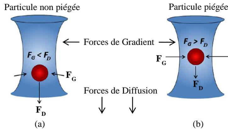
**Figure. 3** Principe de fonctionnement des pinces optiques : (a) les forces de diffusion ( $F_D$ ) dominent les forces de gradient ( $F_G$ ), la particule est déviée de la source de lumière, (b)  $F_G$  domine  $F_D$ , la cellule est optiquement piégée dans la zone d'intensité de lumière la plus forte [24].
