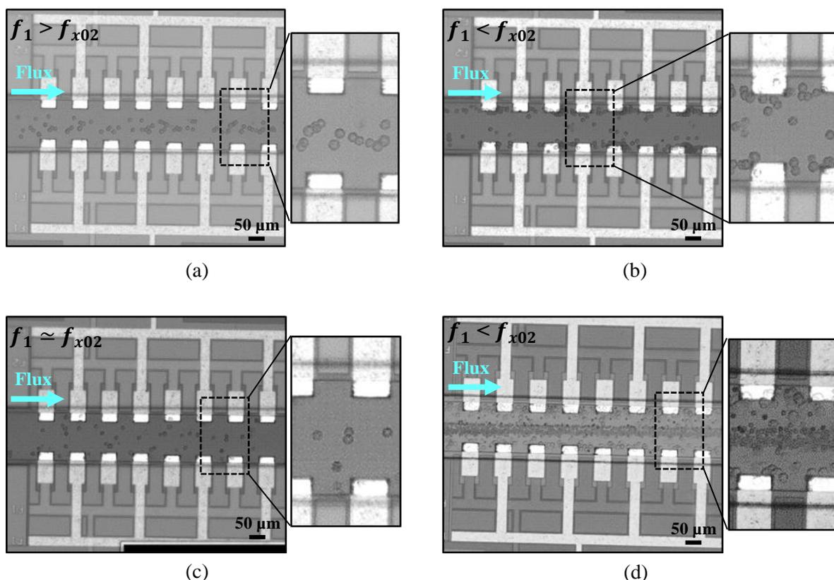
**Figure. 103** Superpositions d'images illustrant le comportement des cellules LN18 en flux, lorsque le cytomètre est polarisé par un signal RF dont la fréquence  $f_1$  est de l'ordre de: (a) 300 MHz, (b) 50 MHz, (c) voisine de 116 MHz. (d) Séparation DEP-UHF de cellules LN18 de billes de polystyrène à une fréquence 50 MHz.
