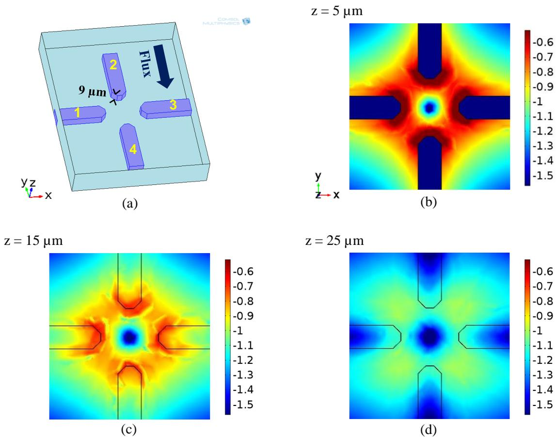
**Figure. 53** (a) Dispositif de caractérisation cellulaire composé de quatre électrodes ayant une épaisseur  $y_{\text{max}} = 9\ \mu\text{m}$ . Distribution du champ électrique généré par la structure aux altitudes : (b)  $z = 5\ \mu\text{m}$ , (c)  $z = 15\ \mu\text{m}$ , (d)  $z = 25\ \mu\text{m}$ .
