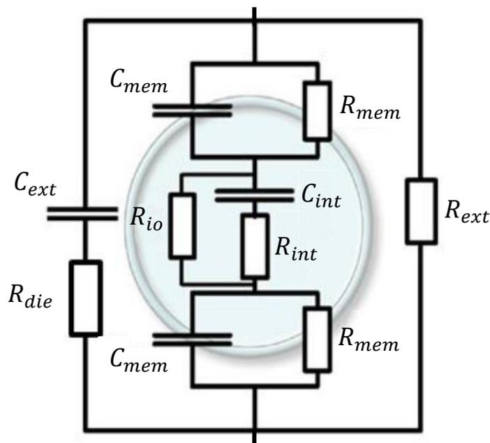
**Figure. 17** Circuit électrique équivalent modélisant une cellule biologique [45].
