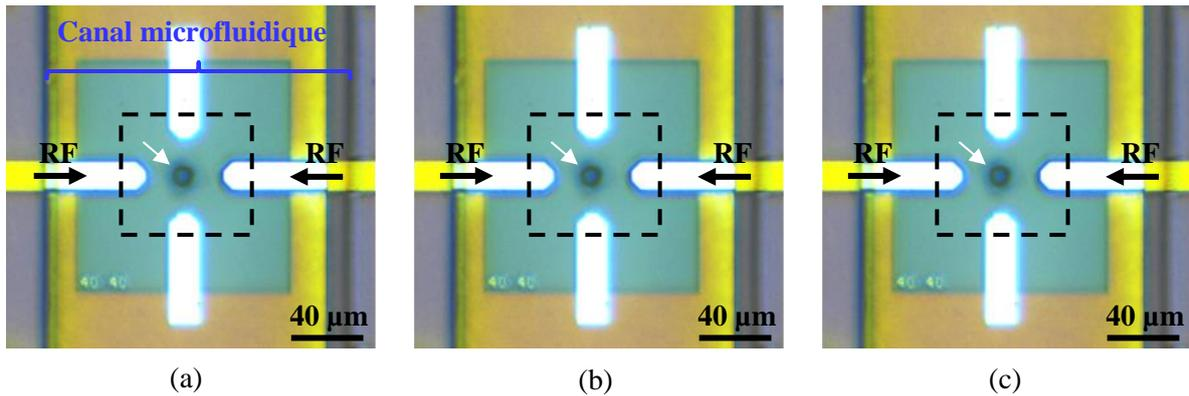
**Figure. 72** Piégeage d'une bille de polystyrène, soumise à un champ électrique non uniforme, au centre des quatre électrodes en DEP négative, pour des fréquences : (a) 100 MHz, (b) 200 MHz, (c) 500 MHz.
