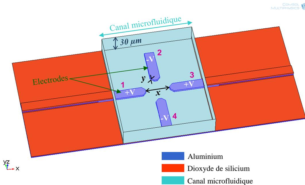
**Figure. 48** Schéma de la structure étudiée par simulation :  $x$  est la variable de l'espace inter-électrodes pour les deux paires d'électrodes et  $y$  est la variable de l'épaisseur des quatre électrodes.
