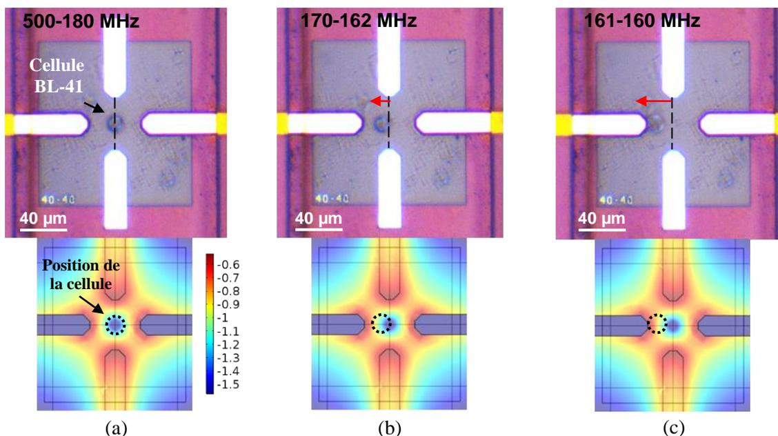
**Figure. 82** Comportement diélectrophorétique UHF de la cellule BL-41, sous l'application d'un signal RF à des fréquences comprises entre 500 et 160 MHz. Sa seconde fréquence de transition mesurée se situe entre 161-162 MHz.
