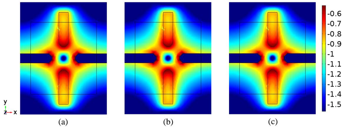
**Figure. 56** Configuration du champ électrique généré par la structure quadripôle pour différentes valeurs de fréquence du champ électrique appliqué : (a) 50 MHz, (b) 200 MHz, (c) 500 MHz à une altitude  $z = 5 \mu\text{m}$ .
