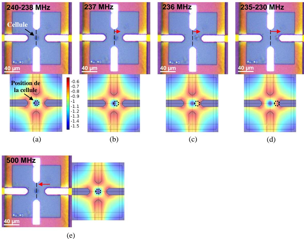
**Figure. 81** (a) à (d) Mouvement diélectrophorétique UHF de la cellule lorsque la fréquence du signal RF est balayée entre 240-230 MHz avec un pas de 1 MHz, (e) piégeage de la cellule à nouveau en DEP négative à 500 MHz. La seconde fréquence de transition déterminée vaut 236 MHz.
