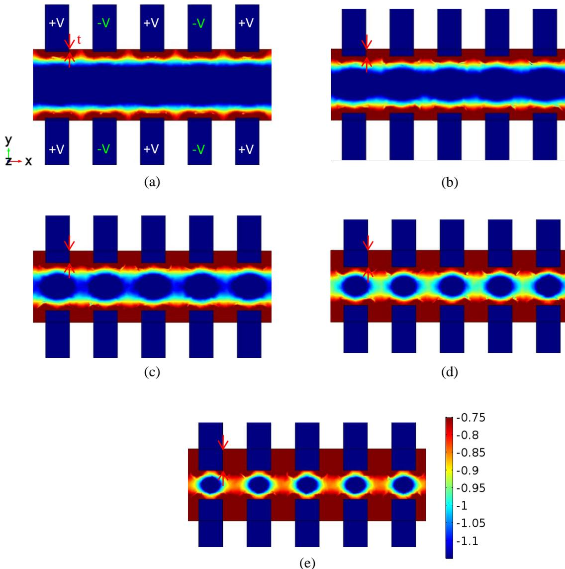
**Figure. 97** Distribution du champ électrique à une altitude  $z = 5 \mu\text{m}$ , générée par le cytomètre pour des pénétrations des électrodes dans le canal de : (a)  $5 \mu\text{m}$ , (b)  $15 \mu\text{m}$ , (c)  $25 \mu\text{m}$ , (d)  $35 \mu\text{m}$  et (e)  $45 \mu\text{m}$ .
