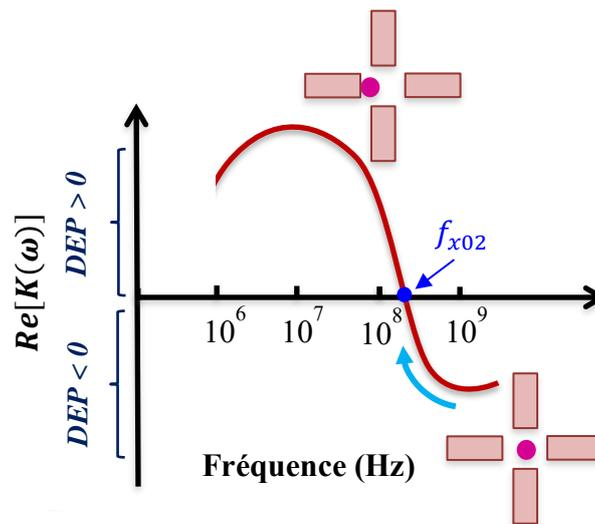
**Figure. 45** Schéma du mouvement de déplacement DEP haute fréquence d'une cellule vivante en fonction de la fréquence du champ électrique appliqué.
