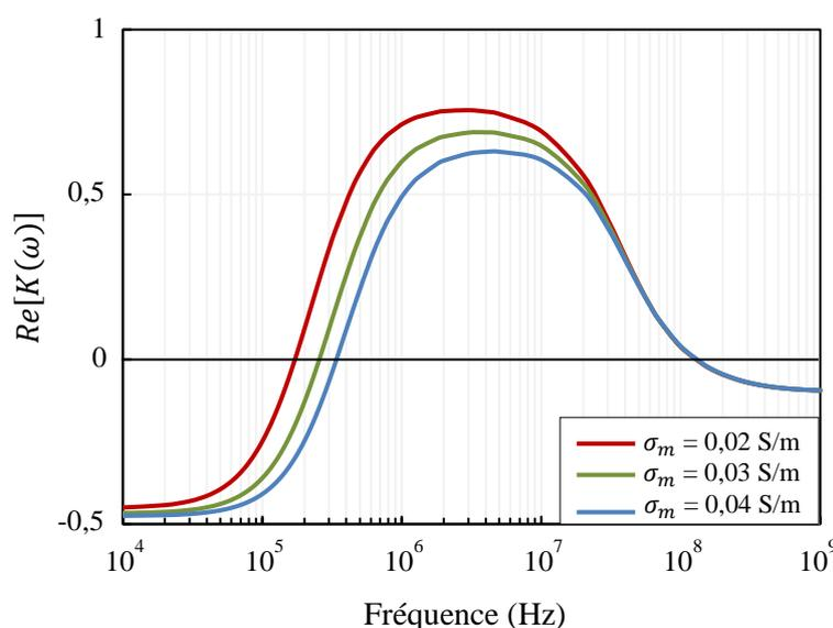
**Figure. 23** Réponse diélectrophorétique théorique d'une cellule de lymphocyte vivante. Effet du changement de la conductivité du milieu de suspension sur les fréquences de transition  $f_{x01}$  et  $f_{x02}$ .
