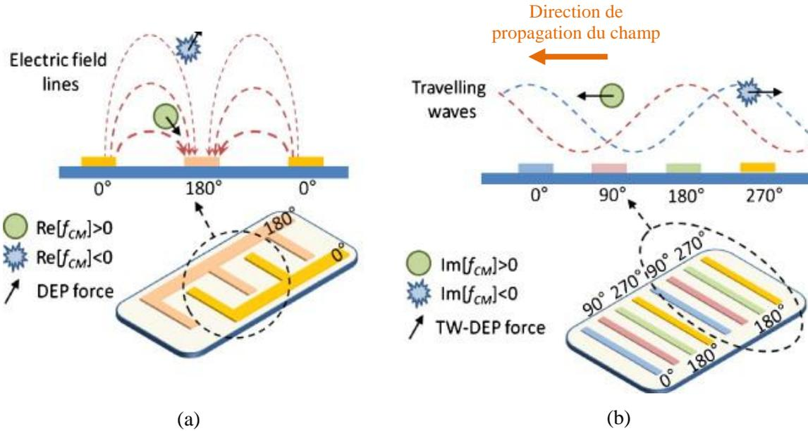
**Figure. 11.** (a) Force de DEP classique créée par la non-uniformité spatiale de l'amplitude du champ électrique appliqué, (b) force de DEP à ondes progressives produite par la non-uniformité spatiale de la phase du champ électrique appliqué [57].
