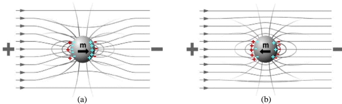
**Figure. 9** (a) Particule plus polarisée que le milieu, le moment dipolaire est aligné avec le champ et les lignes de champ traversent (pénètrent) la particule, (b) particule moins polarisée que le milieu, le moment dipolaire est dans le sens opposé au champ électrique et les lignes de champ contournent la particule [45].
