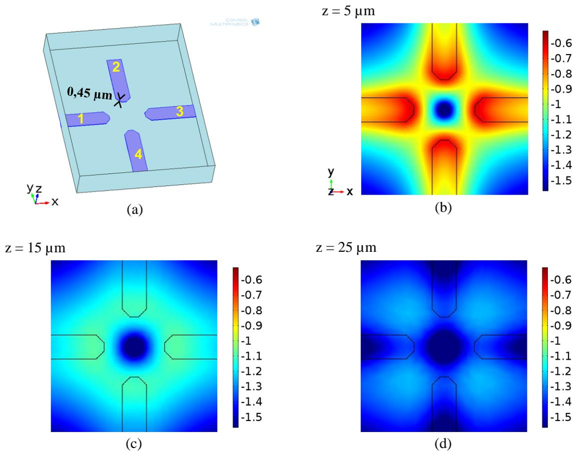
**Figure. 51** (a) Dispositif de caractérisation cellulaire composé de quatre électrodes fines. Distribution du champ électrique généré par les électrodes aux altitudes : (b)  $z = 5 \mu\text{m}$ , (c)  $z = 15 \mu\text{m}$ , (d)  $z = 25 \mu\text{m}$ .
