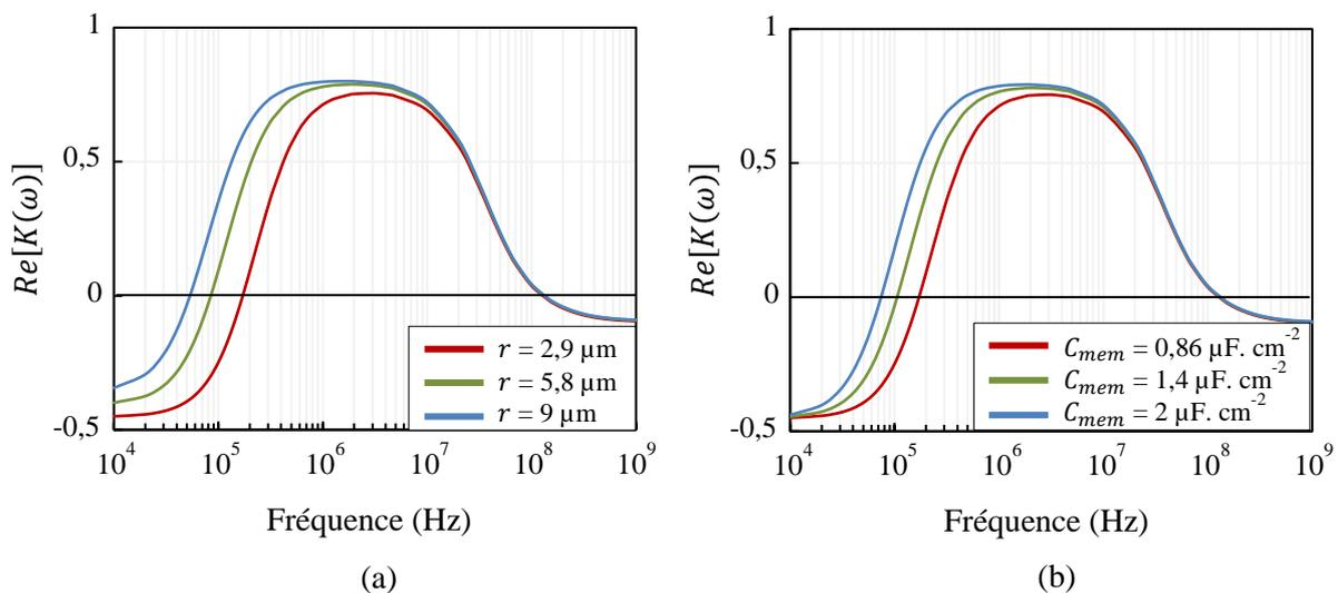
**Figure. 24** Réponse diélectrophorétique théorique d'une cellule de lymphocyte vivante : (a) effet de la variation du rayon de la cellule sur le spectre  $Re[K(\omega)]$ , (b) effet de la variation de la capacité membranaire par unité de surface sur le spectre  $Re[K(\omega)]$ .
