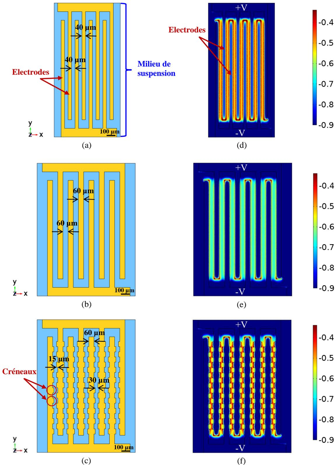
**Figure. 40** (a) et (b) Géométrie de la capacité interdigitée, (c) structure de la capacité interdigitée à créneaux. Distribution du champ électrique, pour une tension  $5 V_{pp}$  à une altitude  $z = 5 \mu\text{m}$ , pour les configurations : de capacité interdigitée avec un réseau d'électrodes d'espace interdigitaire (d)  $40 \mu\text{m}$ , (e)  $60 \mu\text{m}$ , et de (f) capacité interdigitée à créneaux.
