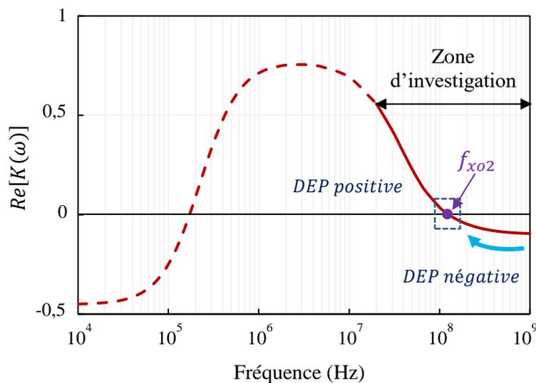
**Figure. 78** Changement du comportement diélectrophorétique UHF théorique d'une cellule vivante (lymphocyte) en fonction de la fréquence du champ électrique appliqué (les paramètres des cellules de lymphocytes ont été présentés dans le [Tableau I-2](#)).
