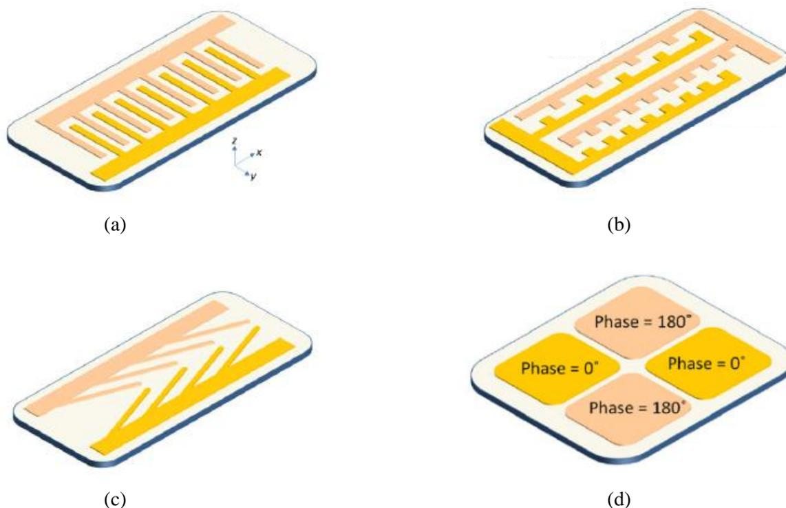
**Figure. 39** Diversité de configurations de microélectrodes pour appliquer des signaux de DEP : (a) électrodes parallèles ou interdigitées, (b) électrodes interdigitées à créneaux, (c) électrodes obliques, (d) quadripôle [57].
