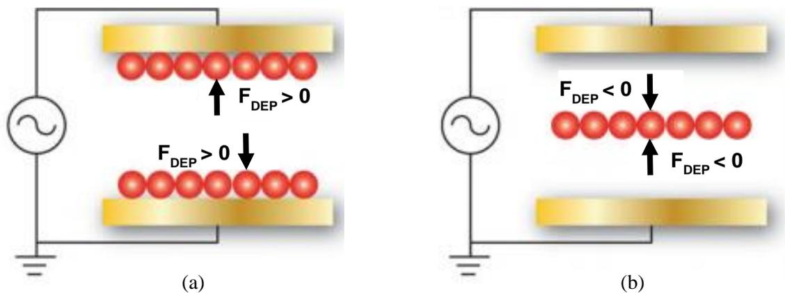
**Figure. 12** Les particules dans un champ électrique non uniforme sont soumises à : (a) des forces de DEP positive en se déplaçant vers la région de forte intensité de champ, ou (b) des forces de DEP négative en se déplaçant vers la région de faible intensité de champ [7].
