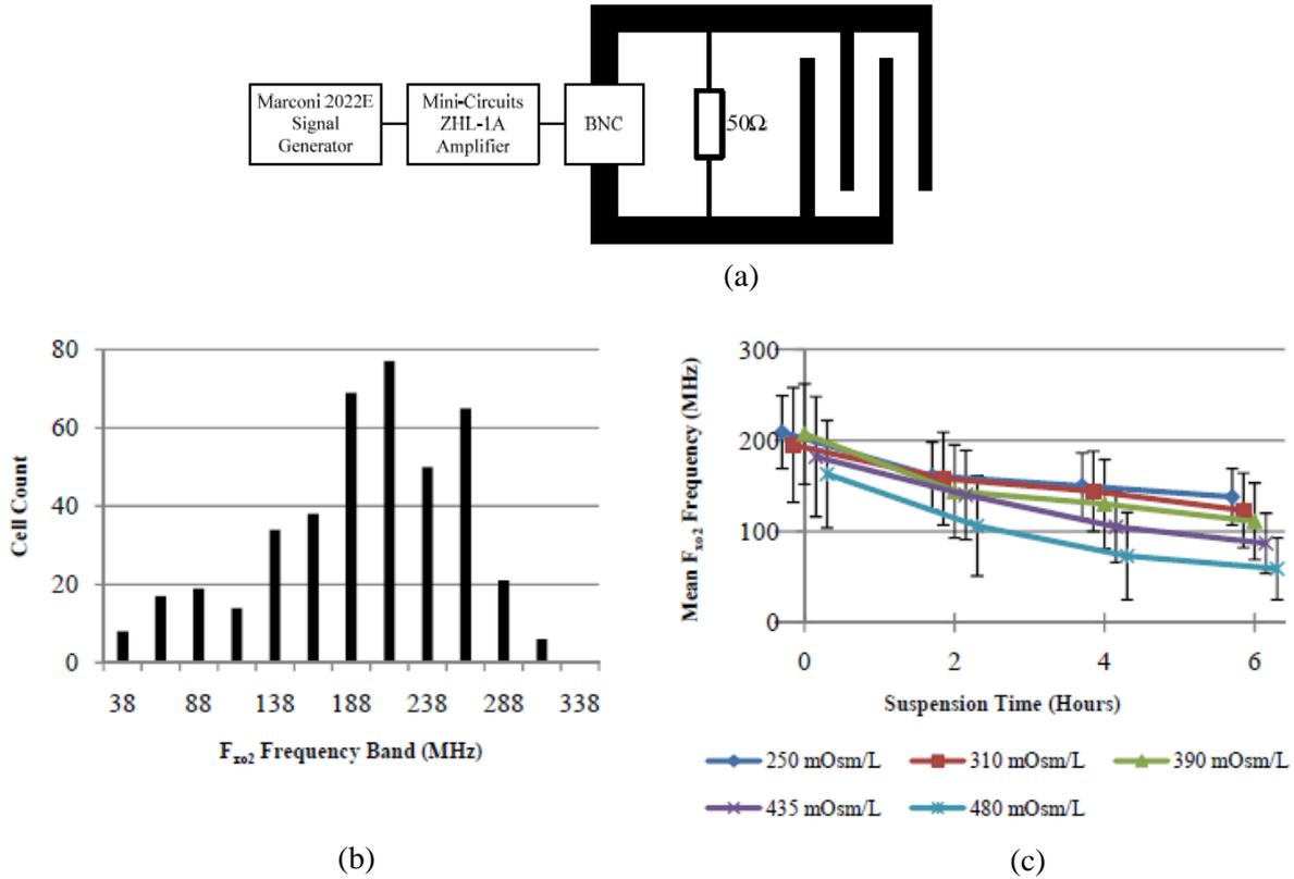
**Figure. 34** (a) Schéma du système électrique haute fréquence, (b) spectre de  $f_{xo2}$  pour les cellules de myélome (n=418) suspendues dans un milieu de DEP possédant une osmolarité 310 mOsm/L et une conductivité 33 mS/m, c) fréquence de transition  $f_{xo2}$  moyenne de cellules de myélome suspendues dans des milieux de DEP possédant différentes osmolarités [88].
