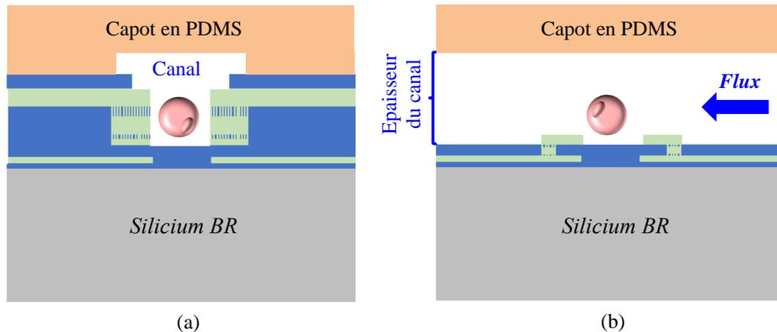
**Figure. 66** Vue en coupe du capot en PDMS contenant la partie supérieure du canal microfluidique, aligné au-dessus du canal fabriqué par IHP, au niveau : (a) des électrodes épaisses, (b) des électrodes fines (pas à l'échelle).
