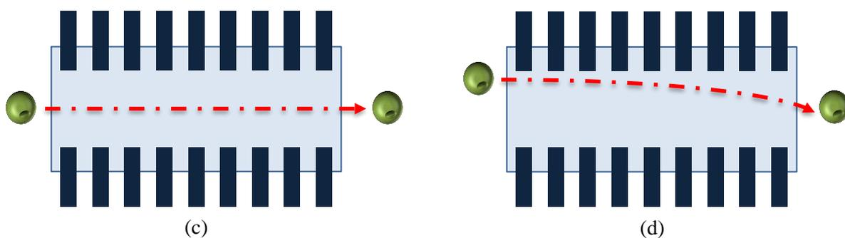
**Figure. 96** Schéma illustrant le comportement diélectrophorétique attendu d'une cellule dans différentes positions dans le canal microfluidique ; cellule réagissant en DEP positive : (a) se déplace aux bords des électrodes, (b) subit une déviation progressive du centre du canal vers les bords des électrodes. Cellule réagissant en DEP négative : (c) se déplace au centre du canal, (d) dévie progressivement des bords des électrodes vers le centre du canal.
