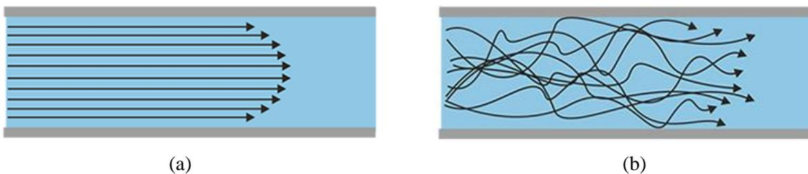
**Figure. 62** Régime d'écoulement (a) laminaire, (b) turbulent [114].
