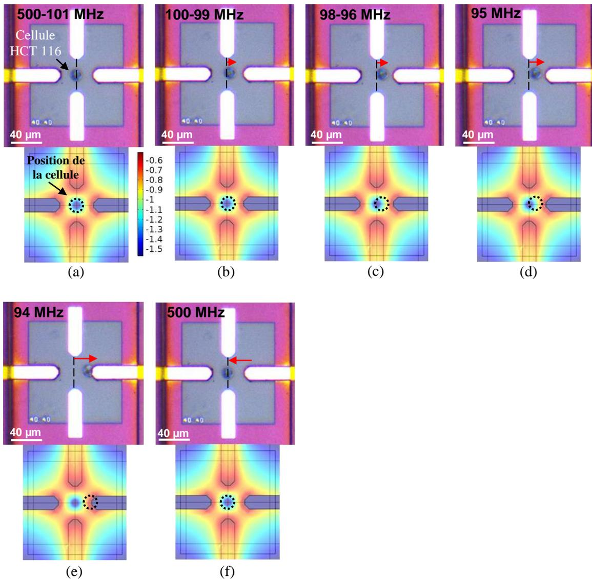
**Figure. 88** Trajectoire DEP-UHF d'une cellule HCT 116 se déplaçant de la DEP négative à la DEP positive, en balayant le spectre de fréquence entre 500-94 MHz. La fréquence de transition mesurée est autour de 95 MHz.
