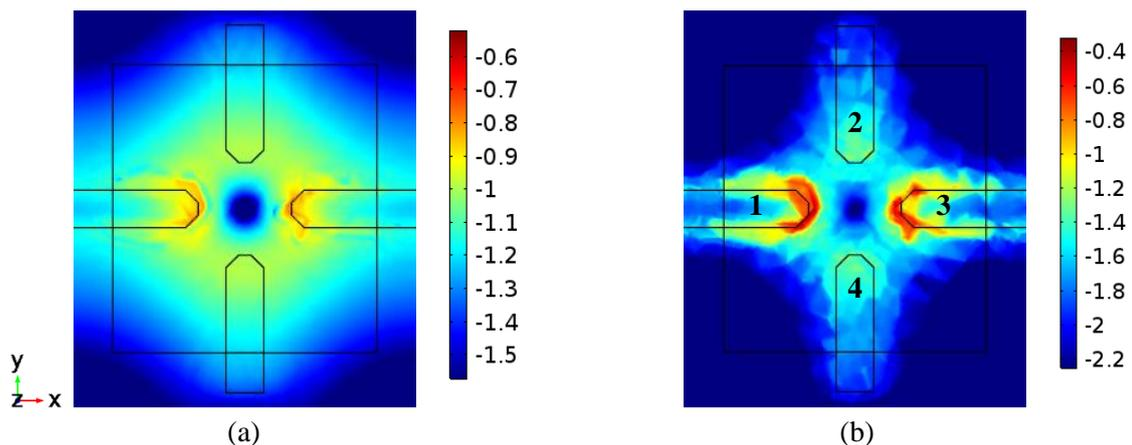
**Figure. 77** (a) Distribution du champ électrique généré par la structure quadripôle à une altitude  $z = 15 \mu\text{m}$  pour une tension  $2 V_{pp}$ , (b) Configuration des forces DEP positives générées par le quadripôle à une altitude  $z = 15 \mu\text{m}$ , dans le cas d'une cellule de diamètre  $12 \mu\text{m}$  plus fortement polarisée que son milieu de suspension.
