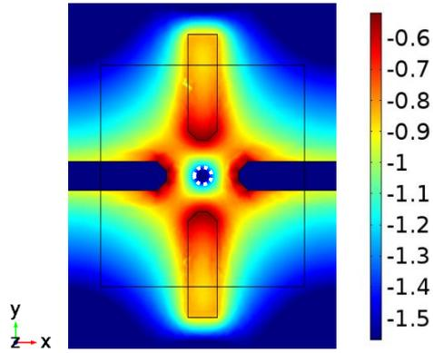
**Figure. 71** Profil de la distribution du champ électrique généré par la structure à quatre électrodes pour une tension de  $2 V_{pp}$ , à une altitude  $z = 5 \mu\text{m}$  dans le canal microfluidique.
