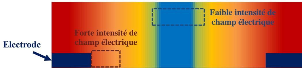
**Figure. 95** Schéma illustrant le gradient de champ électrique à générer sur une section du canal microfluidique, puis à maintenir tout le long de celui-ci.
