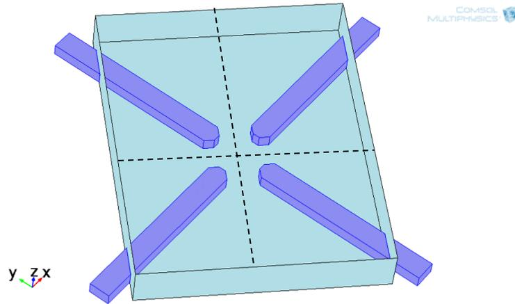
**Figure. 54** Structure à quatre électrodes épaisses disposées à un angle de  $45^\circ$  par rapport au canal microfluidique.
