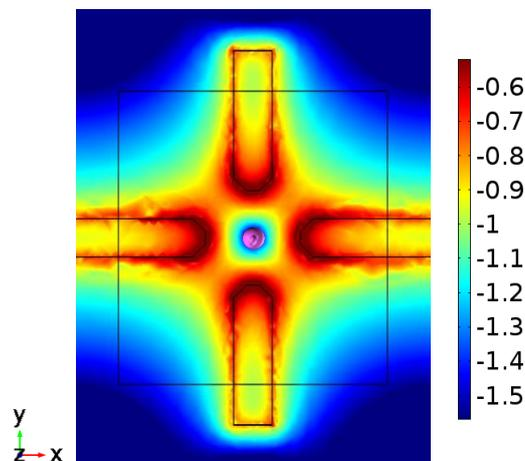
**Figure. 50** Configuration du champ électrique généré pour  $x = 40 \mu\text{m}$  à une altitude  $z = 5 \mu\text{m}$ .
