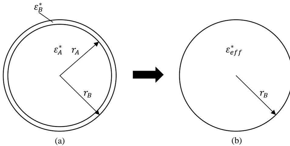
**Figure. 19** Modélisation de deux sphères A et B consécutives par une simple sphère homogène équivalente.
