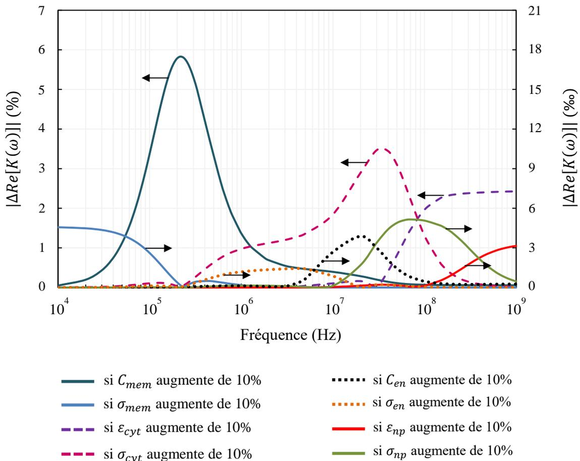
**Figure. 22** Impact sur la valeur absolue de  $Re[K(\omega)]$  de la variation de 10% des valeurs de paramètres diélectriques de la cellule de lymphocyte [77] ayant un rapport nucléocytoplasmique de l'ordre de 0,52, dans un milieu possédant une conductivité de l'ordre de 0,02 S/m.
