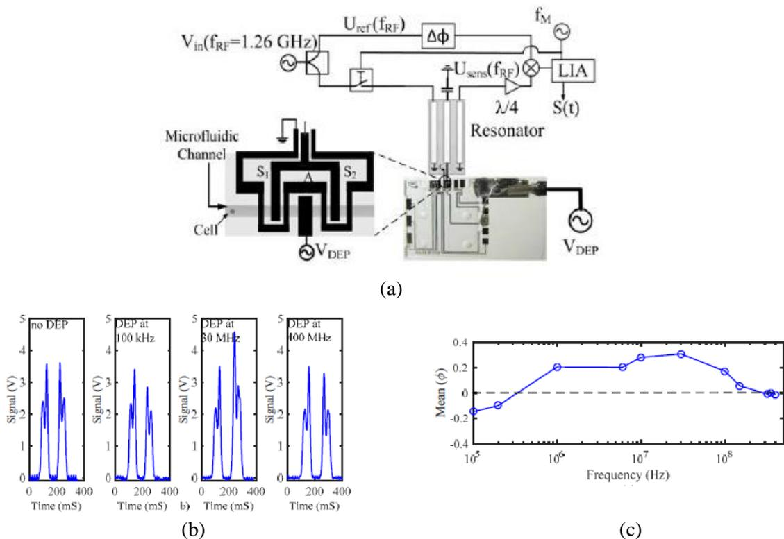
**Figure. 31** (a) Cytomètre DEP large bande, (b) exemples de signatures diélectrophorétiques de cellules d'ovaires d'hamster chinois (CHO) pour différentes fréquences de DEP, (c) spectre de la réponse de DEP des cellules CHO présentant les deux fréquences de transition autour de 400 kHz et 300 MHz [90].
