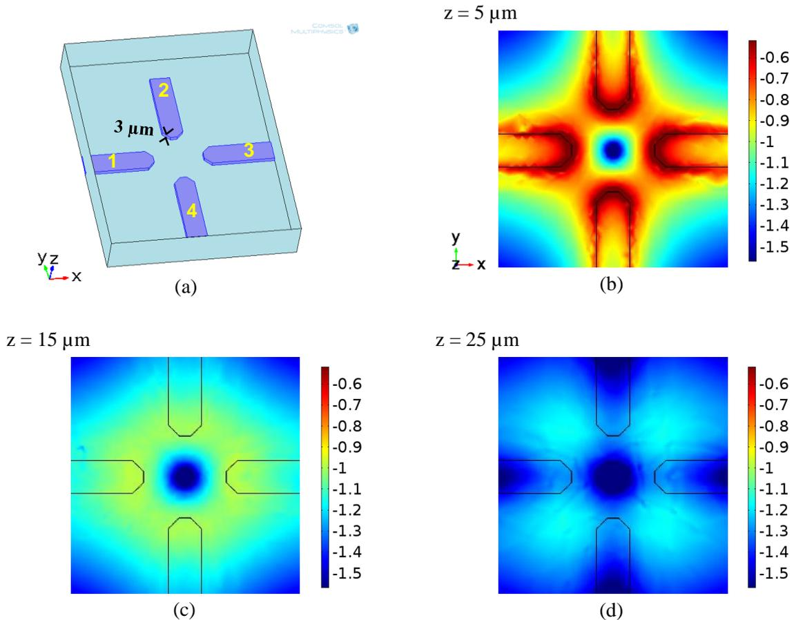
**Figure. 52** (a) Dispositif de caractérisation cellulaire composé de quatre électrodes ayant une épaisseur  $y = 3 \mu\text{m}$ . Profil du champ électrique généré par la structure aux altitudes : (b)  $z = 5 \mu\text{m}$ , (c)  $z = 15 \mu\text{m}$ , (d)  $z = 25 \mu\text{m}$ .
