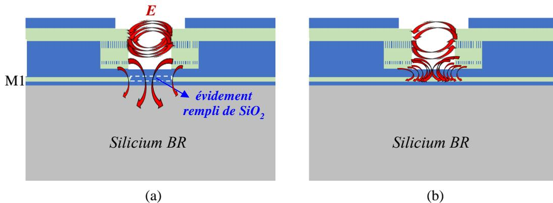
**Figure. 60** (a) Présence de la démétallisation remplie de  $\text{SiO}_2$  dans le plan de masse, (b) absence de l'évidement dans le plan de masse.
