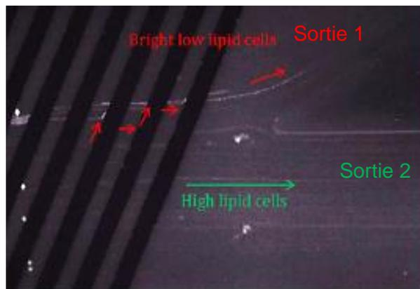
**Figure. 36** (a) Schéma du banc expérimental haute fréquence, (b) séparation des cellules de microalgues de faible et forte teneur en lipides sous l'action d'un champ électrique appliqué à 50 MHz pour une tension 30  $V_{\text{pk-pk}}$  [102].
