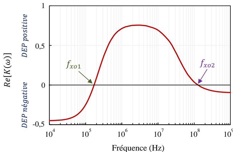
**Figure. 20** Réponse diélectrophorétique théorique d'une cellule de lymphocyte vivante avec les paramètres présentés dans le Tableau I-2, en suspension dans un milieu possédant une permittivité  $\epsilon_m = 78\epsilon_0$  F/m et une conductivité  $\sigma_m = 0,02$  S/m.
