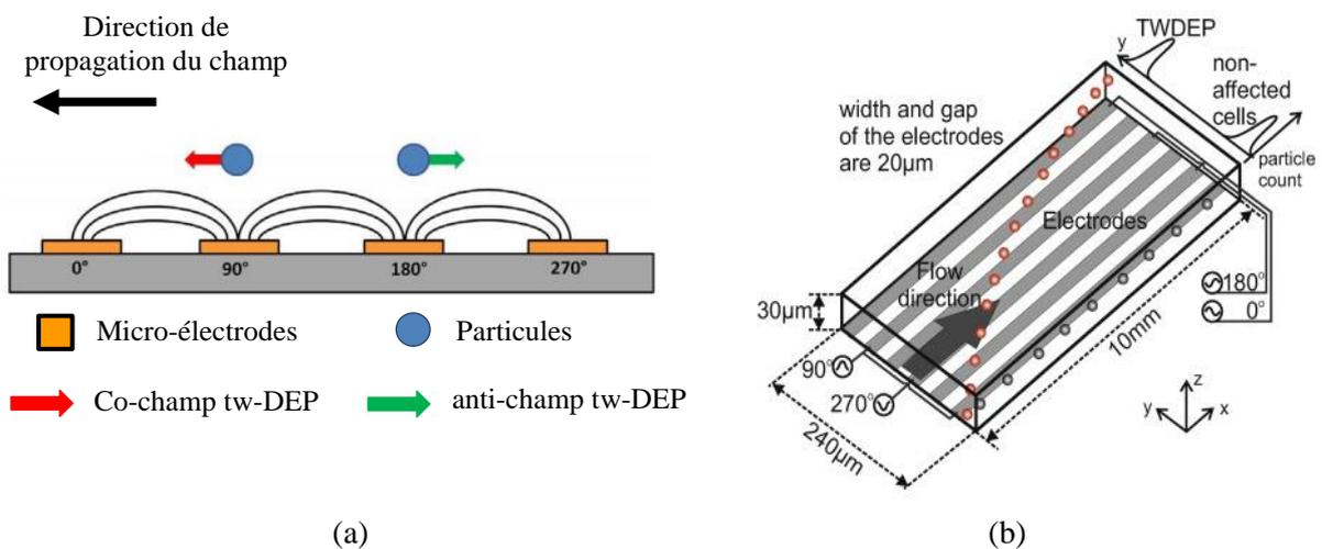
**Figure. 13** (a) Schéma d'illustration du mouvement induit pour une particule sphérique dans le cas de la *tw-DEP* [58], (b) principe de séparation des cellules par la *tw-DEP* [59].
