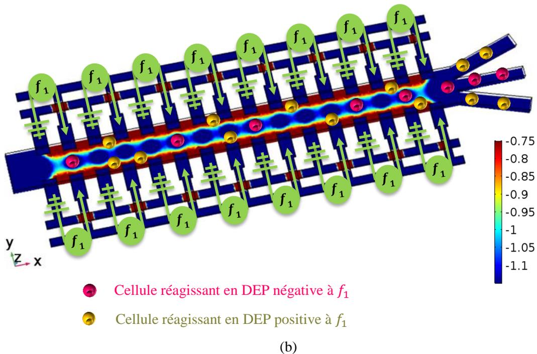
**Figure. 98** (a) Géométrie du cytomètre électromagnétique, (b) schéma de principe de fonctionnement du cytomètre pour une pénétration des électrodes dans le canal de l'ordre de 25  $\mu\text{m}$ , avec  $f_1$  représentant la fréquence du fonctionnement.
