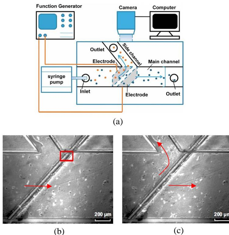
**Figure. 28** (a) Schéma de principe du dispositif du tri DEP. Mesures expérimentales de la déflexion DEP des cellules HCT116 : (b) en l'absence du champ électrique, les cellules HCT116, HEK293 et E. coli se déplacent en flux dans le canal principal, (c) en présence du champ, les cellules HCT116 ont été déviées vers le canal latéral et les HEK293 et E. coli continuent à se déplacer dans le canal principal [48].
