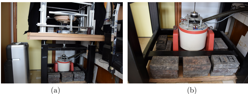
FIGURE 2.2 – Photo du montage. (a) : Vue du montage global. Le vibreur est installé sur des planches maintenues par des briques en plomb, au-dessus duquel est fixée une tige qui transmet la vibration verticalement au plateau. (b) : Photo du vibreur.
