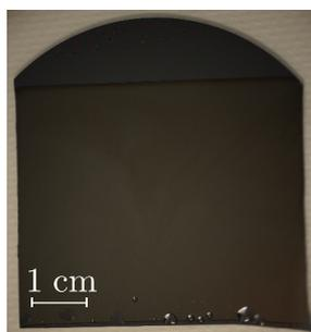
FIGURE 2.4 – Plaque : *wafer* de silicium découpé en rectangle avec revêtement de fluoro-polymères (FC725).
