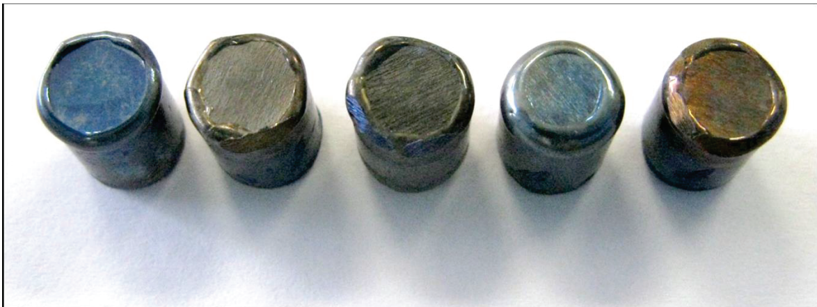
Figure III.33 – Photographie de creusets en Ta suite à un traitement thermique de 240 heures à 1273 K en ampoule scellée et une trempe à l'eau
