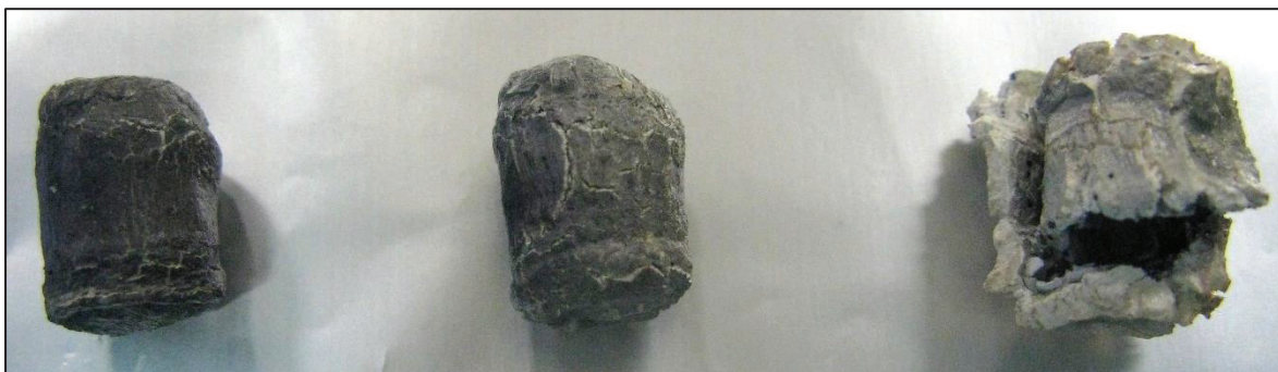
Figure III.26 – Creusets en Ta oxydés après un traitement thermique à 1273 K pendant 260 heures dans une ampoule en quartz comportant une fuite
