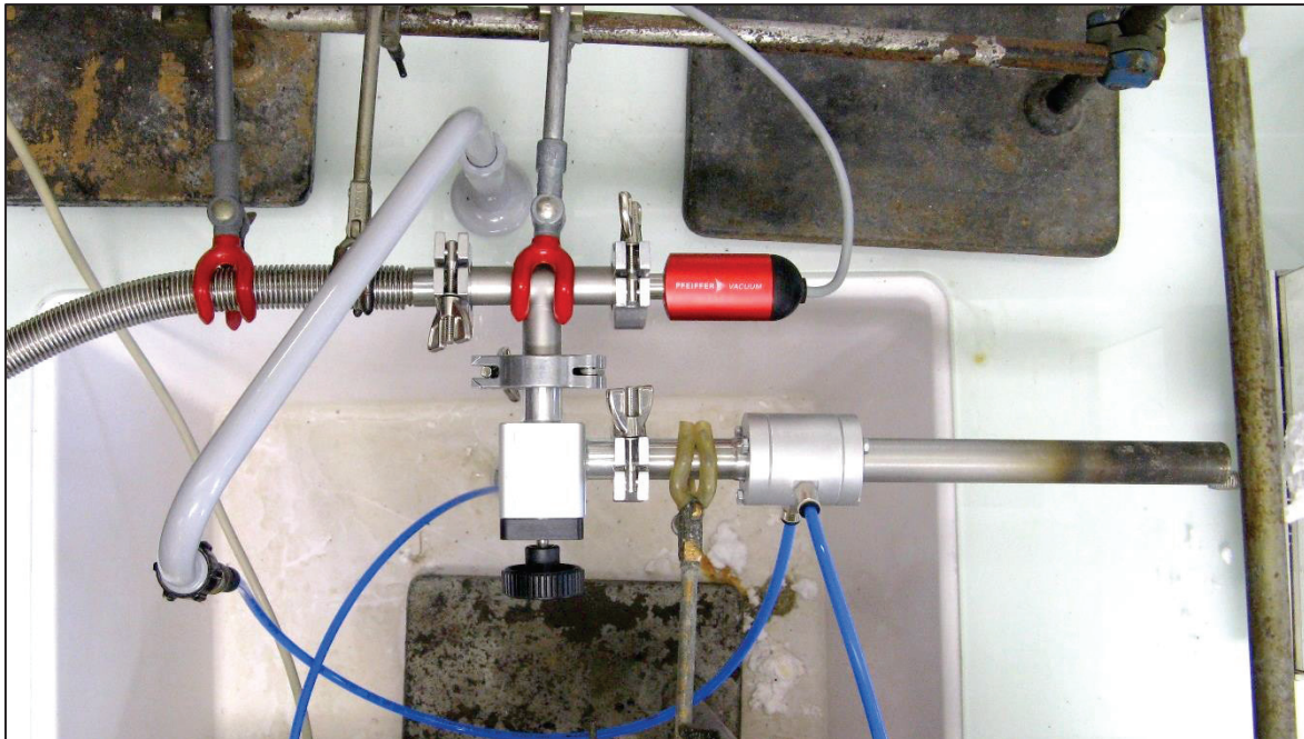
Figure III.29 – Le dispositif expérimental d'évaporation de matrice Mg-Al avant d'introduire le tube en acier dans le four radiant
