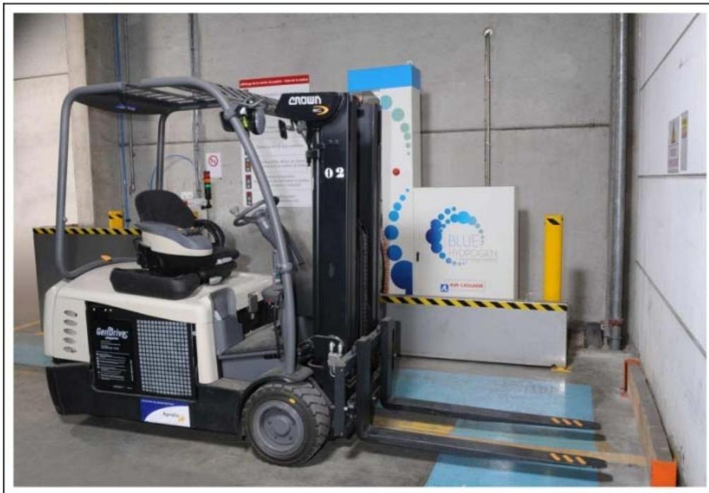
**Figure II. 6 : Chariot élévateur HyPulsion. Avec une puissance de 10 kW et de l'hydrogène stocké à 350 bar, le chariot a une autonomie de 8 heures et le plein d'hydrogène s'effectue en 3 minutes[25] .**
