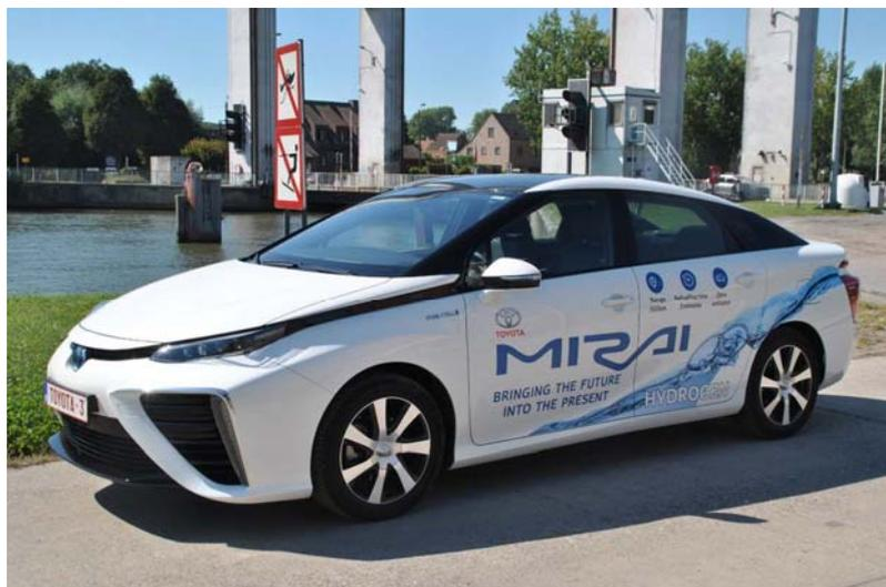
**Figure II. 5 : Toyota Mirai à pile à combustible (PEMFC) commercialisée depuis décembre 2014 au Japon.**
