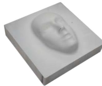
Figure 89 : Visage usiné servant de pièce test
