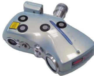
Figure 4 : Capteur laser Zephyr doté de cibles de suivi
